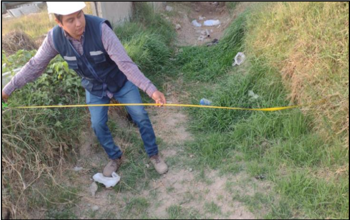
Figura.36 Toma de medida de las secciones en campo
