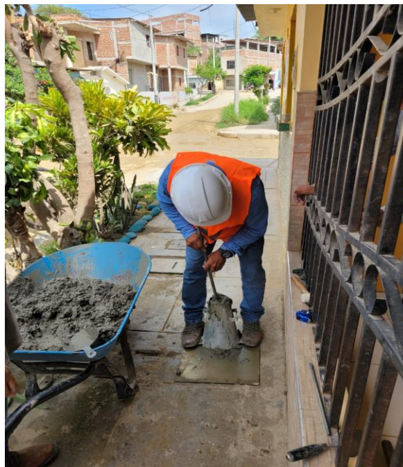
Figura 39: Chuceando en el cono de Abrams
