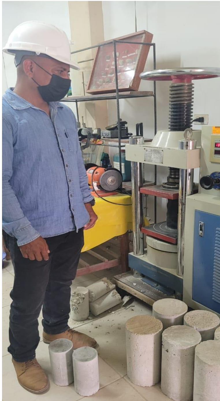
Figura 46: Rotura de probetas
