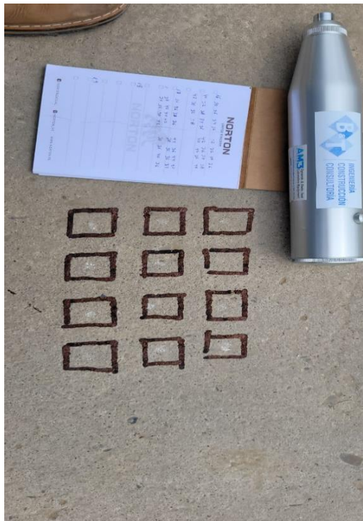
Figura 33: El esclerómetro usado
