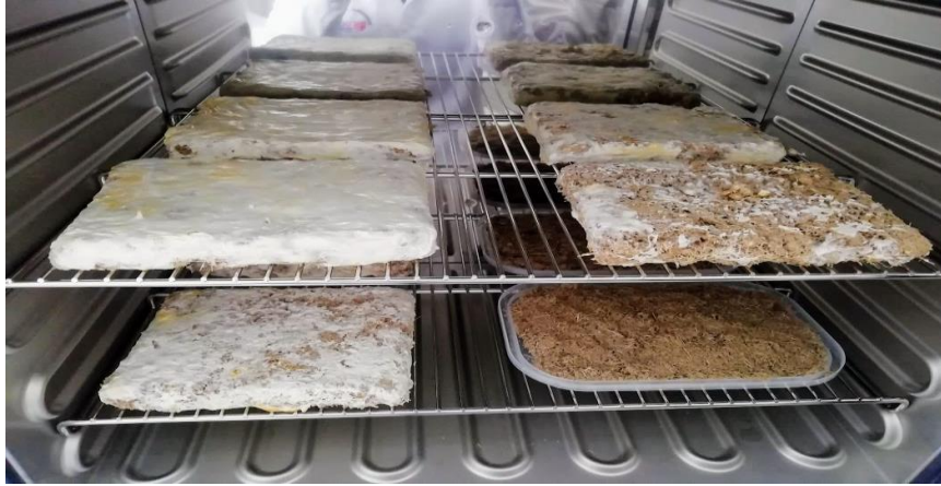
Figura 78: Fase de inhibición del micelio en la estufa de secado a 60°C por 24hr
