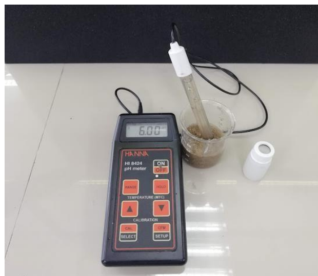
Figura 14: Medición el pH dando como resultado 6, valor bajo
