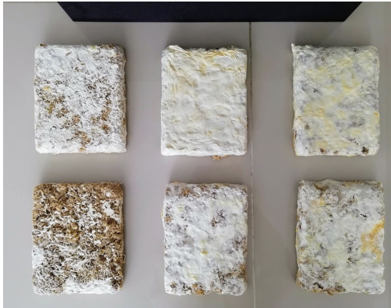
Figura 7: Biomateriales obtenidos de la muestra "M3" con 300 g bagazo y 100 g de micelio
