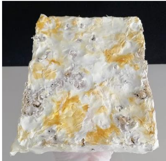
Figura 78: Fase de inhibición del micelio en la estufa de secado a 60°C por 24hr
