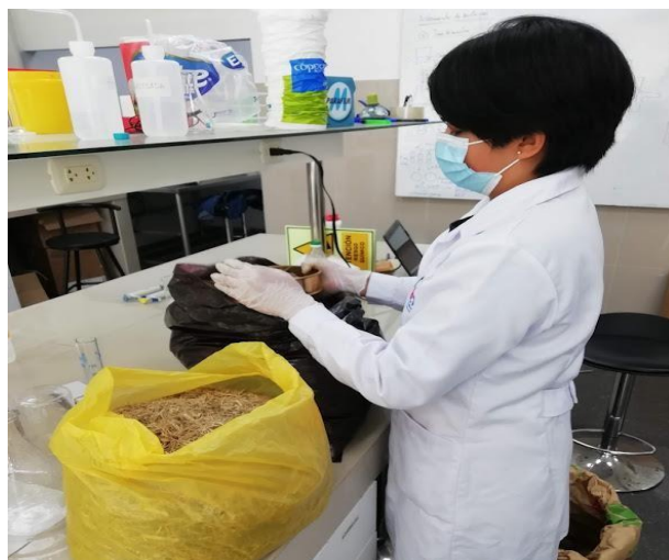
Figura 11: Proceso de tamizado del sustrato con un tamiz de 2mm
