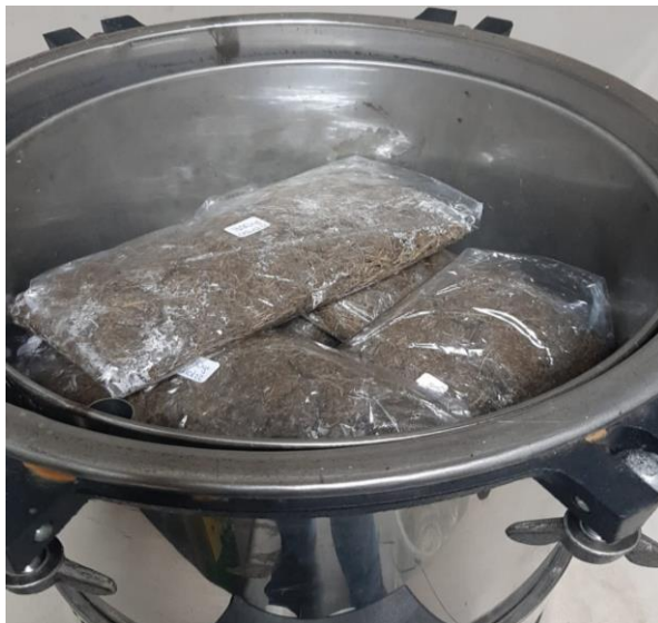
Figura 25: Se colocó el sustrato en la autoclave a 120 ° C por 30 min
