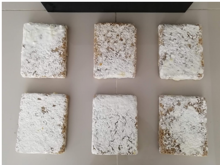
Figura 6: Biomateriales obtenidos de la muestra "M2" con 320 g bagazo y 80 g de micelio
