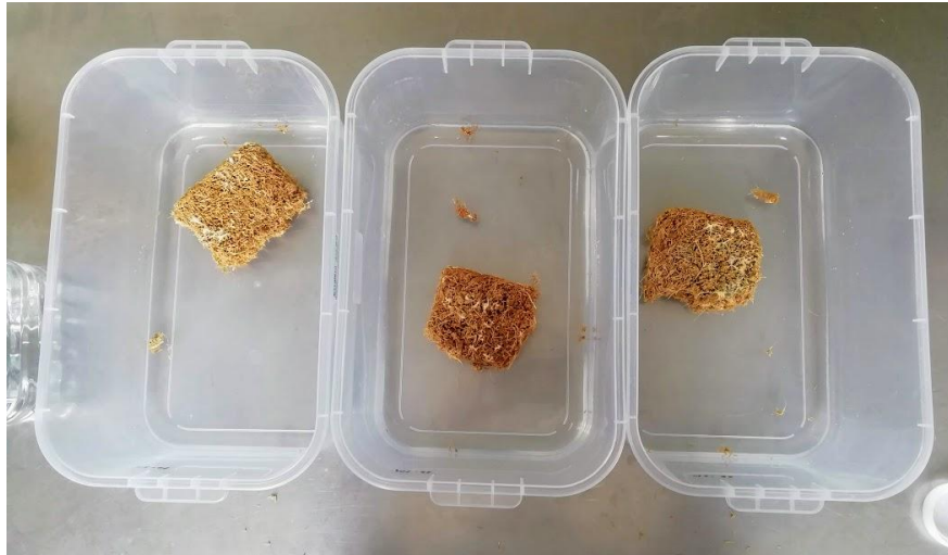
Figura 4: Biomateriales sumergidos en recipientes con agua destilada para prueba de absorción de agua.
