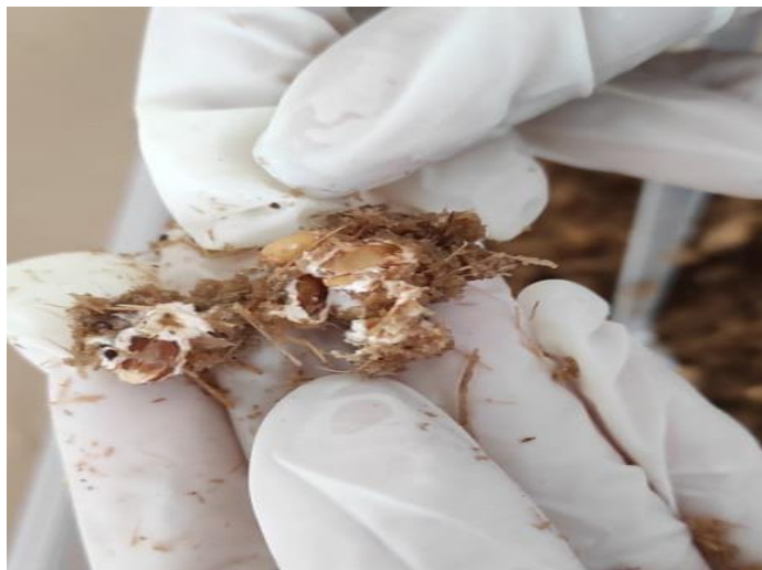
Figura 40: Adherencia de micelio en partículas del bagazo de caña de azúcar.
