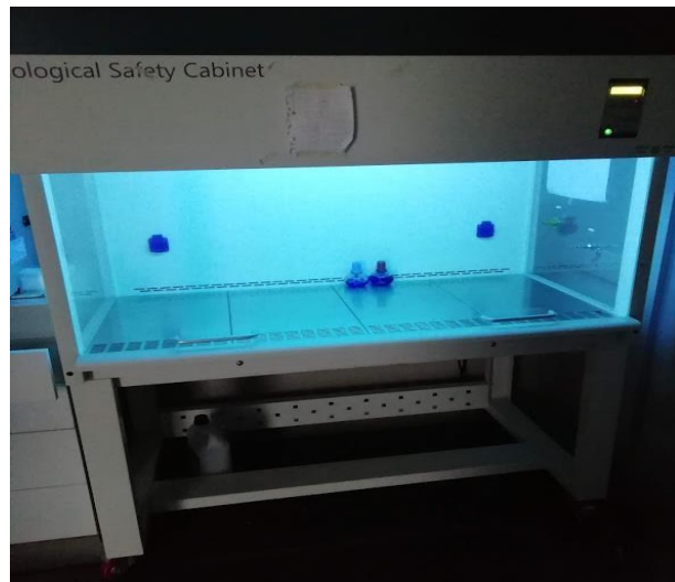
Figura 27: Desinfección de la cabina con rayos UV
