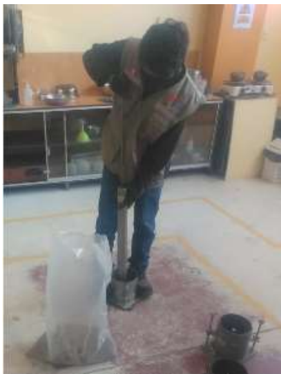
Foto 15. Realizacion de golpes por por capa por el Metodo B
