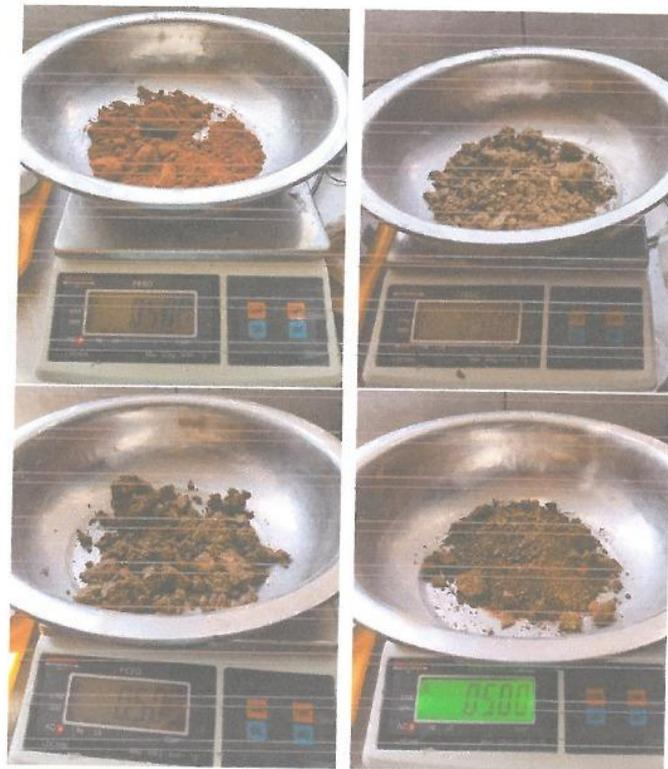
Figura 2. Muestra para análisis granulométricos.
