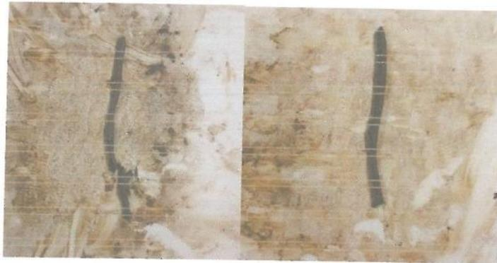
Figura 9. Ensayo de Limite plastico, utilizando material pasante malla N°40.
