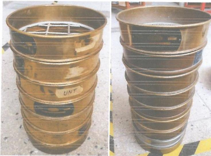
Figura 4. Mallas colocas en orden según Norma ASTM D 422.
