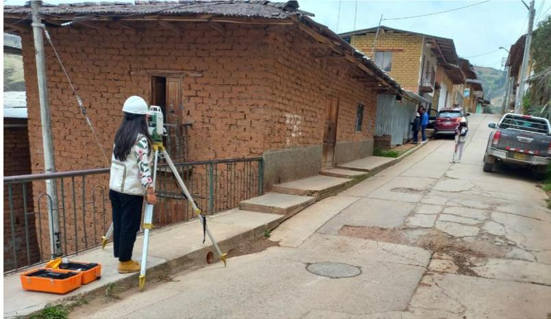
**Foto N° 01:** Realizando el levantamiento topográfico del Barrio José Gálvez
