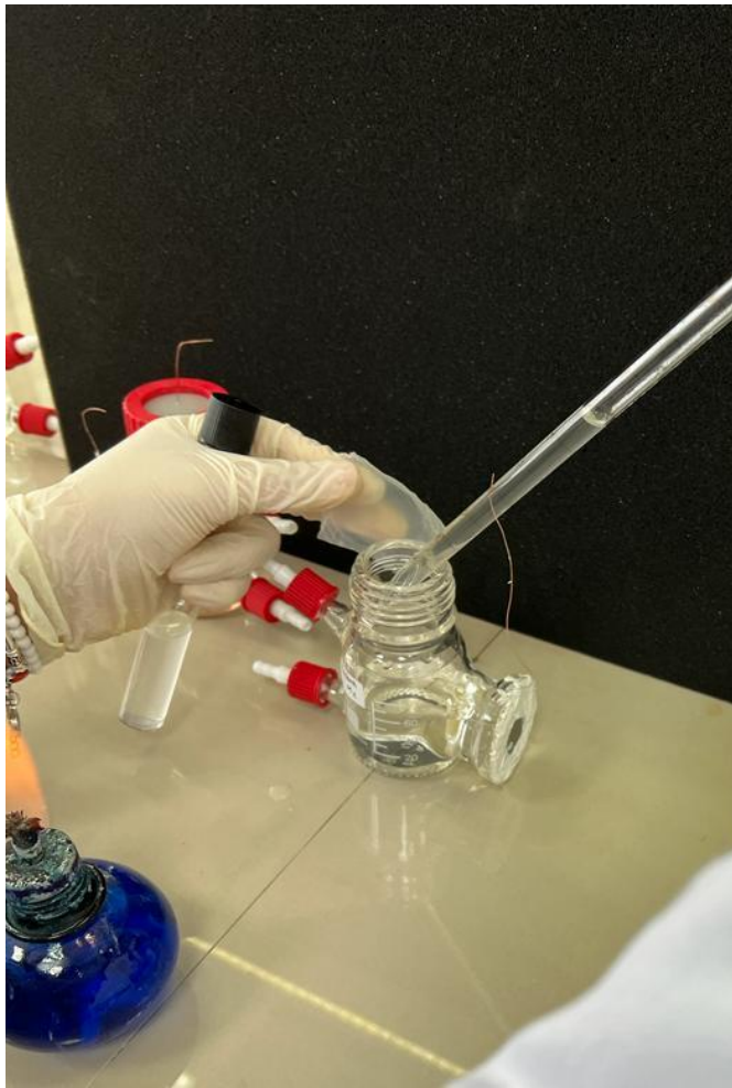
Figura a7: Celda de combustible microbiana de una cámara inoculada con microorganismos.
