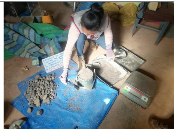
Fotografía 10. Ensayo para la obtención del peso unitario suelto seco del agregado
