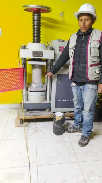
Fotografía 23. Ensayo de rotura de las briquetas para obtener la resistencia a la compresión
