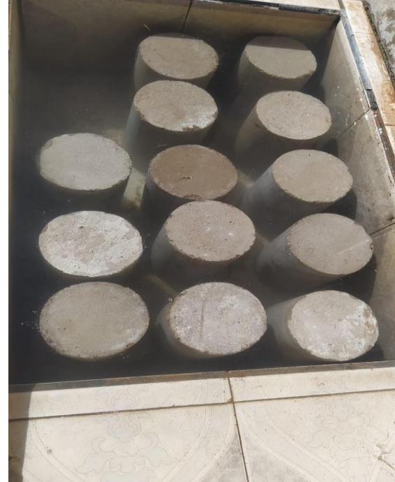
Fotografía 30. Curado de las probetas de concreto de forma convencional.
