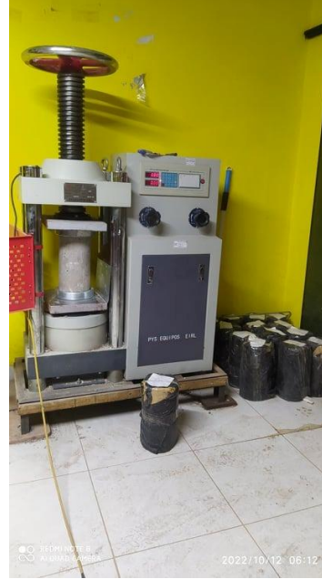
Fotografía 22. Ensayo de rotura de las briquetas para obtener la resistencia a la compresión
