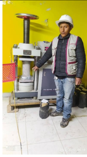
Fotografía 24. Ensayo de rotura de las briquetas para obtener la resistencia a la compresión
