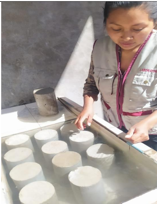
Fotografía 27. Curado de las probetas de concreto de forma convencional
