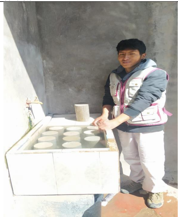
Fotografía 28. Curado de las probetas de concreto de forma convencional
