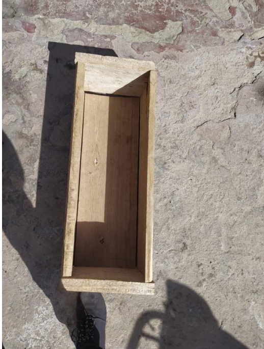
Fotografía 25. Molde para el vaciado del concreto
