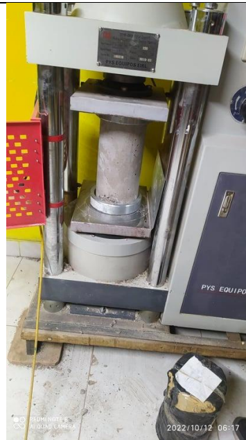
Fotografía 20. Ensayo de rotura de las briquetas para obtener la resistencia a la compresión
