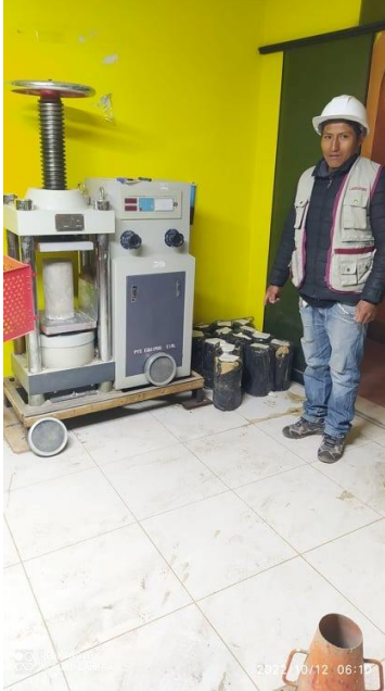
Fotografía 21. Ensayo de rotura de las briquetas para obtener la resistencia a la compresión
