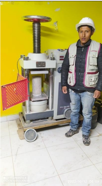
Fotografía 19. Ensayo de rotura de las briquetas para obtener la resistencia a la compresión
