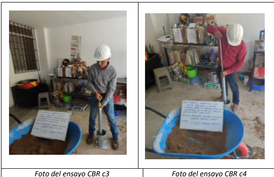
Figura 15. Ensayo CBR en estado natural de las c2 y c3.
