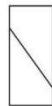
Tipo 4 Fractura diagonal sin fisuras a través de los extremos; golpe suave con un martillo para distinguir del Tipo 1
