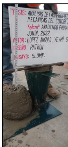
Figura 13. Realizando el ensayo de slump. Fuente: Elaboración propia.
