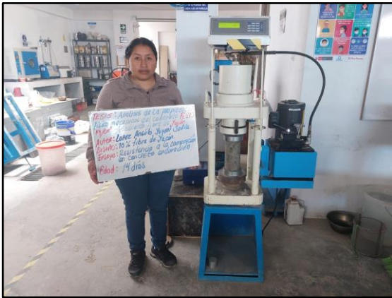
Figura 17. Ensayo a la compresión.
