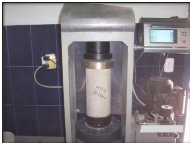
Figura 4. Ensayo a la compresión.
