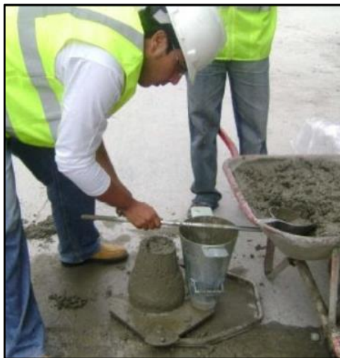
Figura 2. Ensayo de Slump.
