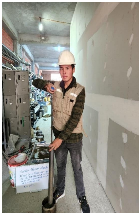
Figura 11. Compactación del suelo mediante el martillo, ensayo de Proctor modificado NTP 339.141.
