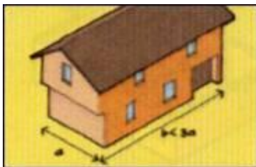
Vulnerabilidad media: irregularidad en planta.
