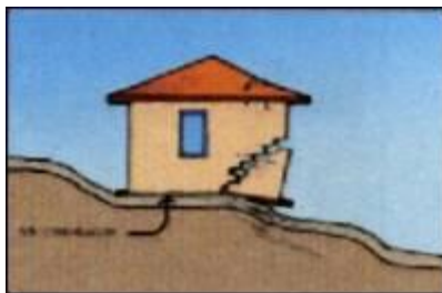
Vulnerabilidad alta: cimentación.
