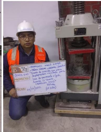
Rotura de probetas y viguetas
