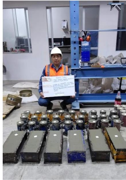
Elaboración de probetas y viguetas
