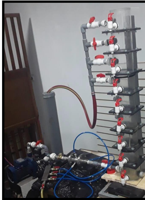
Figura 9. Tratamiento del relave minero en el equipo de Generador de micronanoburbujas de aire
