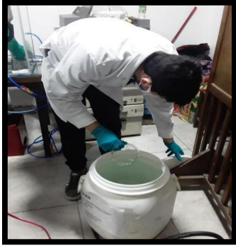
Figura 4. Homogenización de la muestra del relave minero
