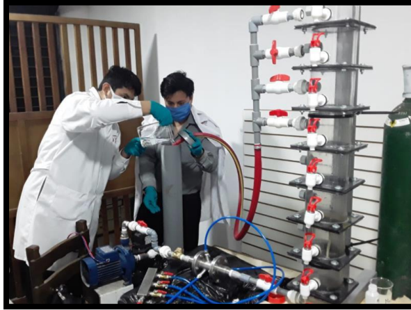
Figura 6. Llenado del relave en el depósito de muestra del generados de Nb. Fuente: Propia.
