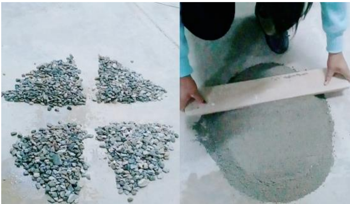
Fotografía N° 2: cuarteo de agregados fino y grueso para tomar la muestra uniforme para la granulometría.
