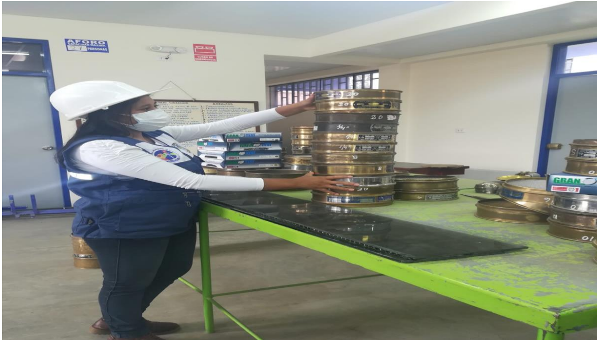
Figura N° 7. Tamizaje manual del agregado grueso para determinar las distribuciones de partículas necesarias para el control de granulometría y su posterior uso del material.
