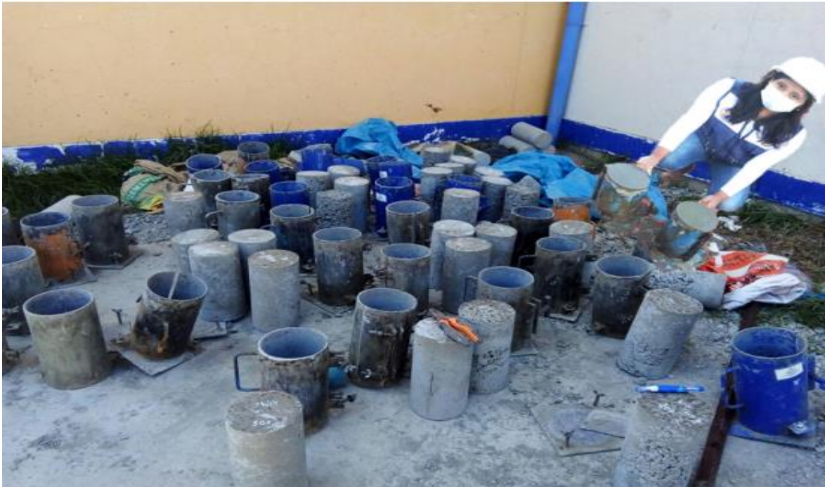
Figura N° 19. Limpieza de moldes de probeta para elaboración de probetas.
