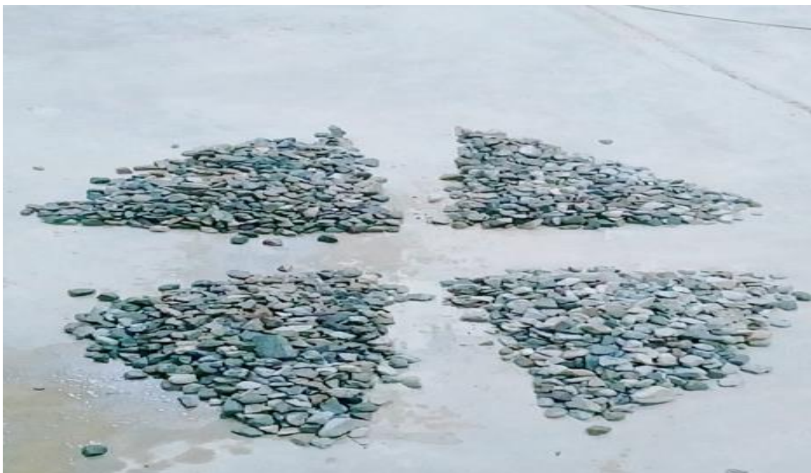
Figura N° 5. Cuarteo de agregado grueso para tomar la muestra uniforme para la granulometría.
