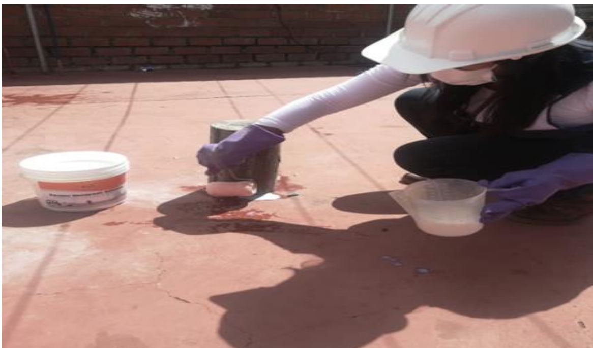
Figura N° 21. Curado de concreto con Membranil Reforzado con dos y tres capas.
