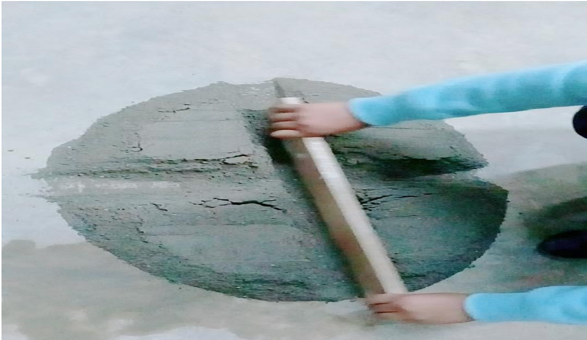
Figura N° 9. Cuarteo del agregado fino para tomar la muestra uniforme para realizar la granulometría.
