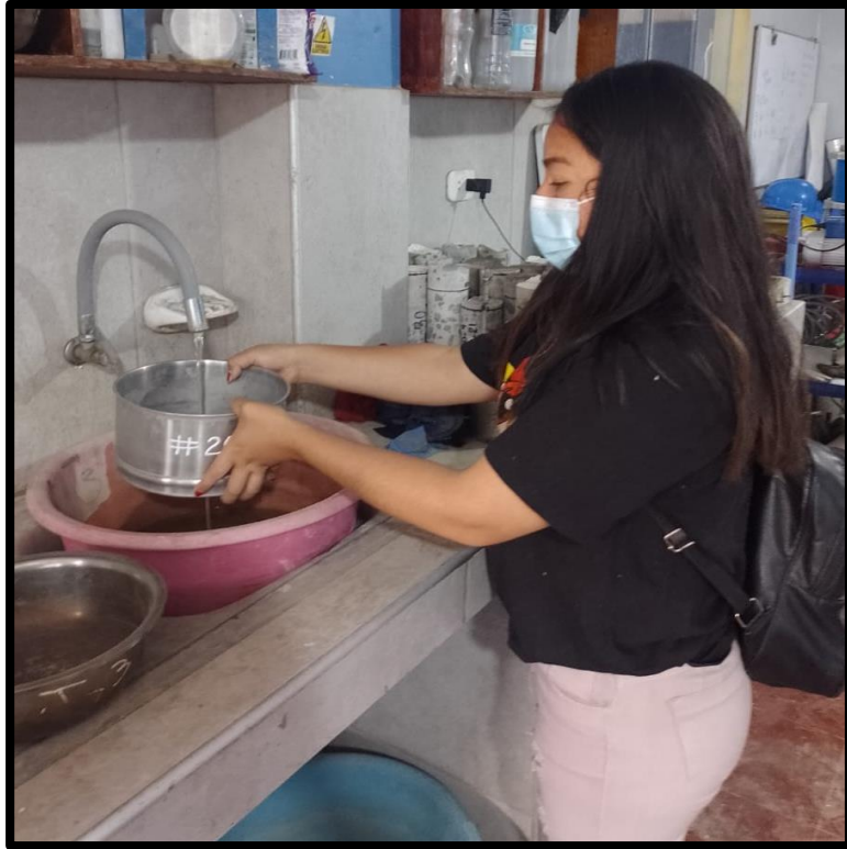
Fotografía 7. se realiza el lavado de la muestra.
