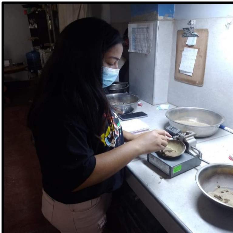
Fotografía 10. Ensayos para límite de atterberg.
