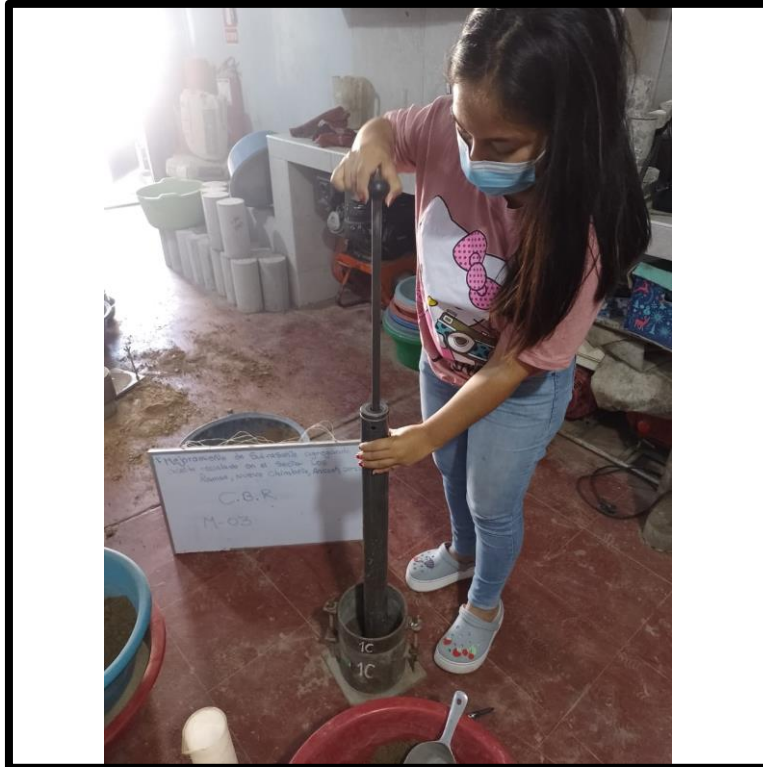
Fotografía 15. Se realizaron los golpes en las 3 capas de la muestra con el martillo compactador.
