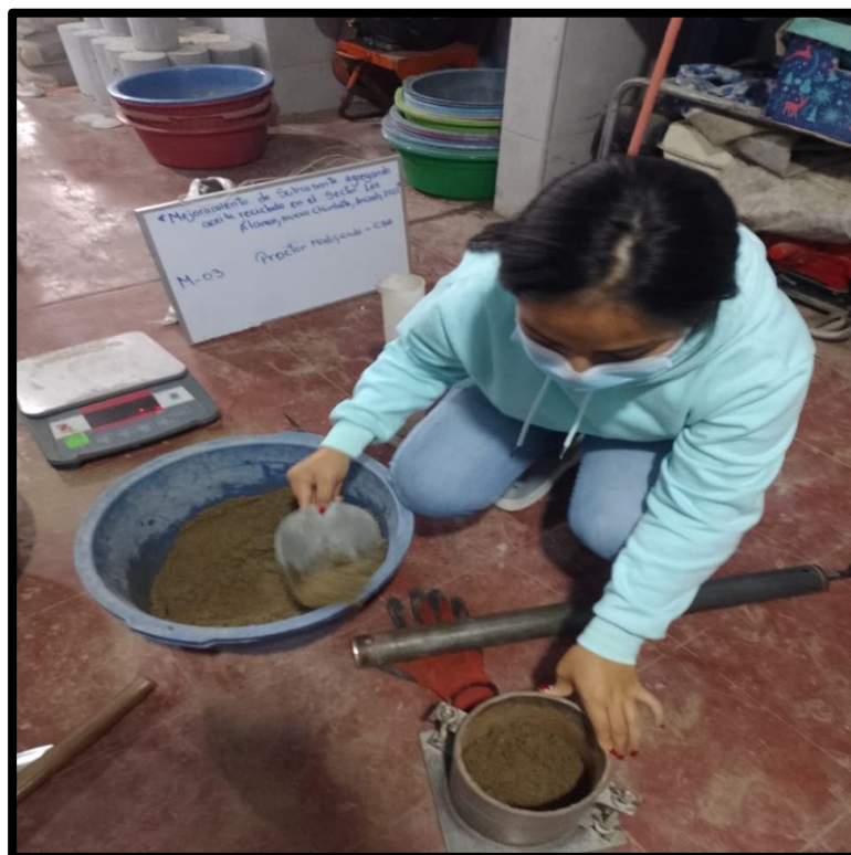
Fotografía 12. Se realizaron los ensayos de Proctor modificado.
