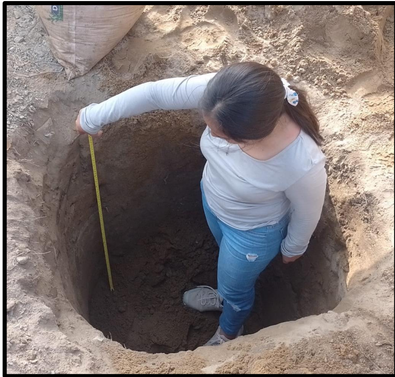
Fotografía 1. Se realizaron las calicatas a una profundidad de 0.50 m a 1.50 m.
