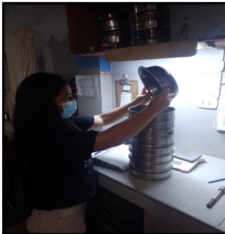
Fotografía 4. Se realizó la distribución por tamaño de la arena a través de las mallas.
