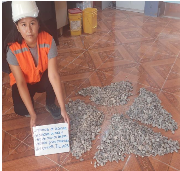
Figura 24. Cuarteo de agregado Grueso
