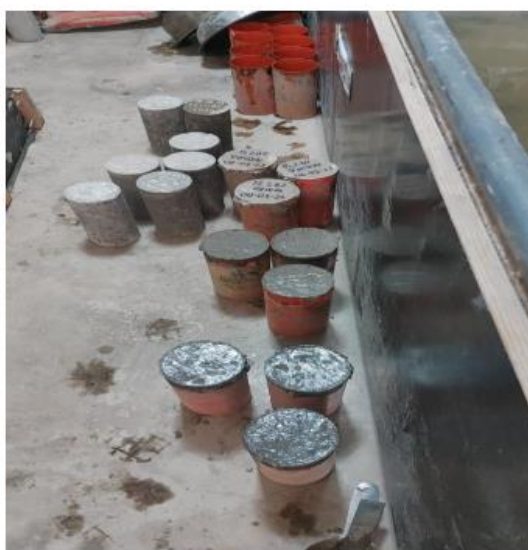
VACIADO DE CONCRETO EN PROBETAS CILINDRICAS
