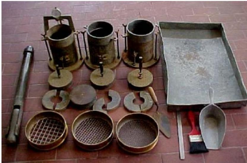
Figura 2. Instrumentos utilizados en el ensayo de CBR
