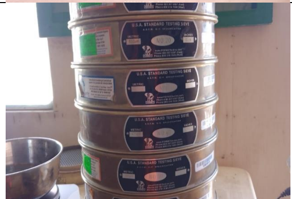
Ensayo de límites de consistencia y granulometría del suelo utilizado para la elaboración de los adobe
