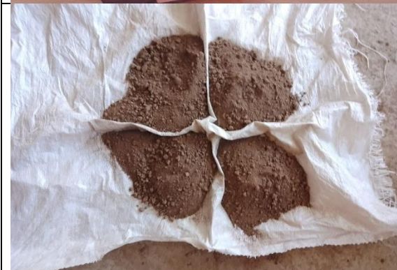
Ensayo de límites de consistencia y granulometría del suelo utilizado para la elaboración de los adobe
