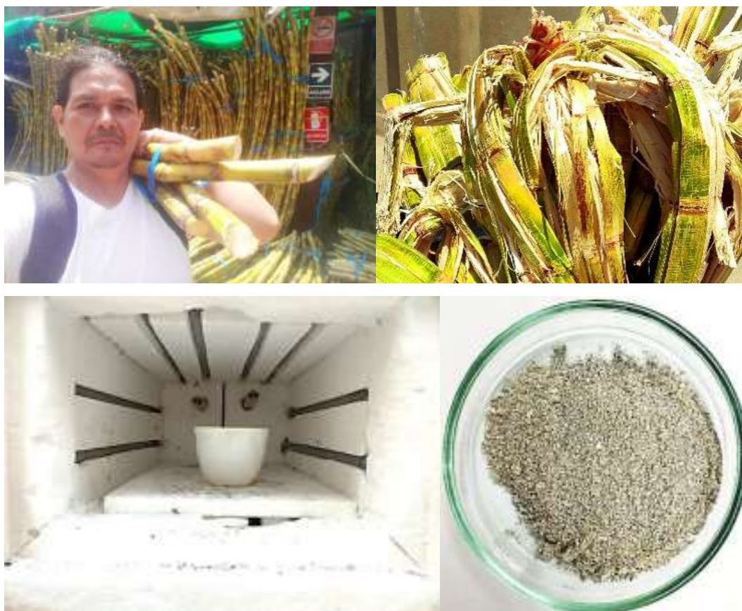
Figura 24. Elaboración de la ceniza de bagazo de caña.
