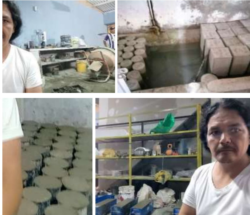
Figura 4. Elaboración y curado de las probetas, elaboración propia.
