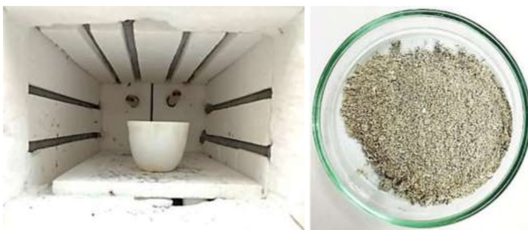
Figura 12. Calcinado del bagazo, fuente LABICER, 2023
