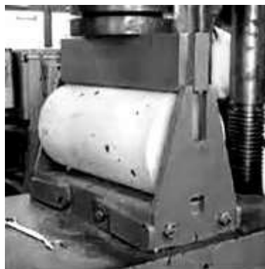
Figura 6. Resistencia a la tracción del concreto (Sindić, 2019).
