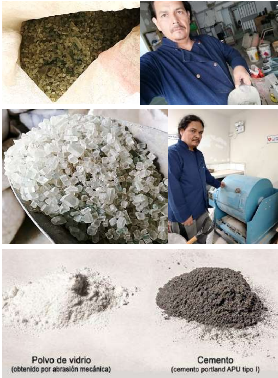
Figura 25. Elaboración del polvo de vidrio.
