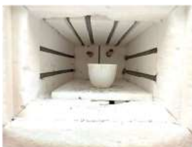
FIGURA N°2. CALCINACIÓN DE LA MUESTRA DE BAGAZO DE CAÑA DE AZÚCAR EN LA MUFLA (DAIHAN SCIENTIFIC) A 650°C.
