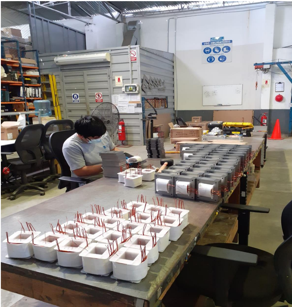
Figura 23: Proceso de Laminado manualmente de Bobinas de los transformadores Fuente: ELISE S.A.C.
