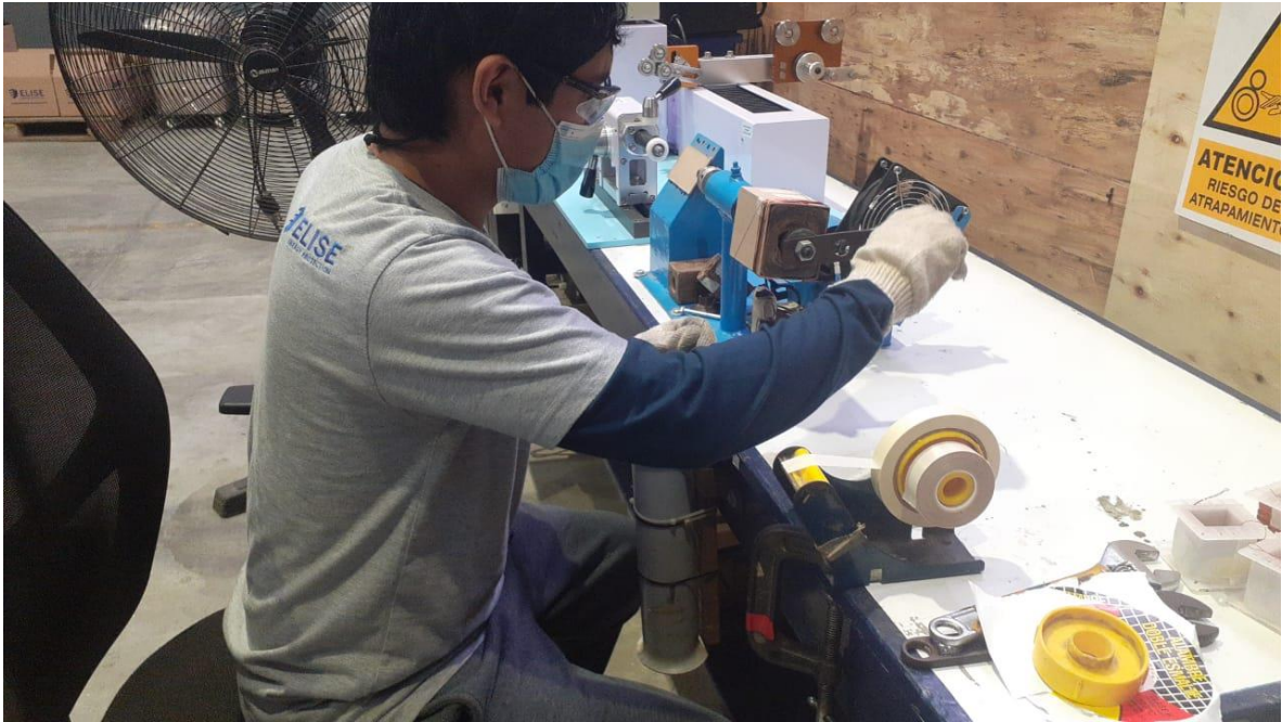
Figura 1: Personal realizando el Bobinado manualmente. Fuente: ELISE S.A.C.
