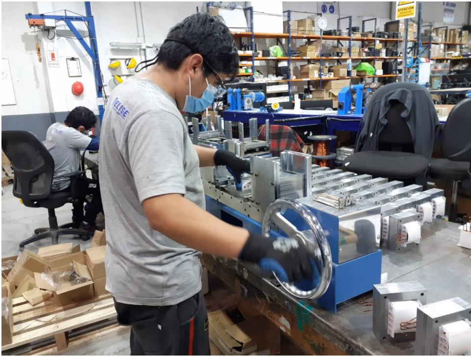
Figura 30: Personal capacitado utilizando la Máquina Laminadora Fuente: ELISE S.A.C.
