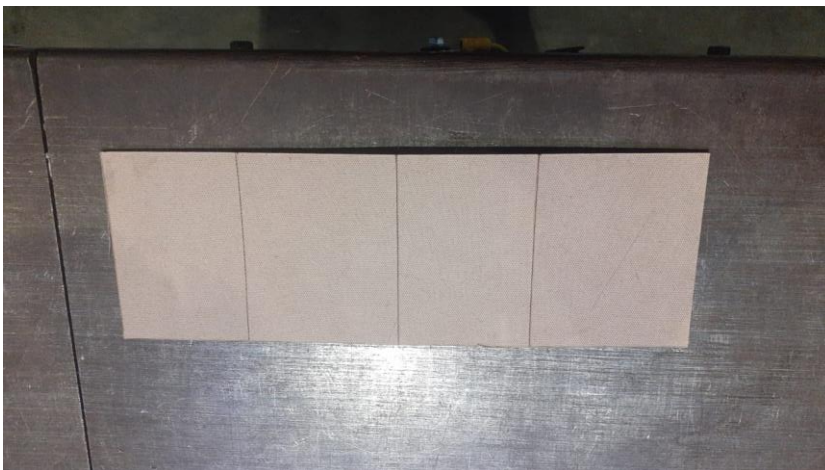
Figura 2: Forma hecho de cartón presspan según las medidas del diseño. Fuente: ELISE S.A.C.
