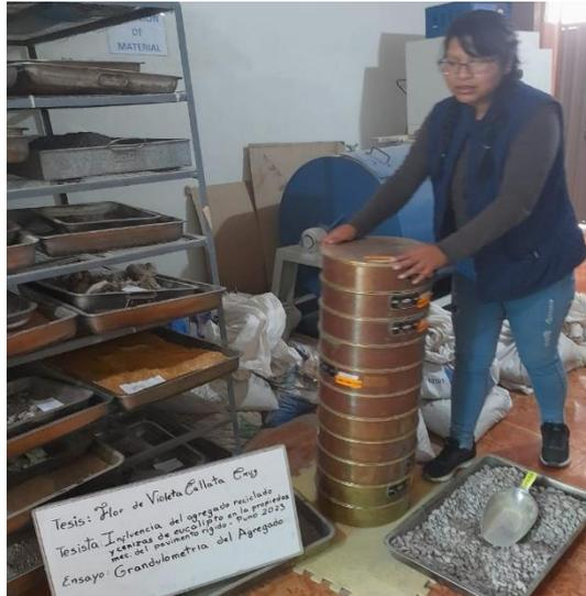
figura 31. Análisis granulométrico
