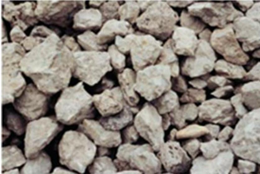
*figura 7. Forma y textura de un agregado de concreto reciclado*
