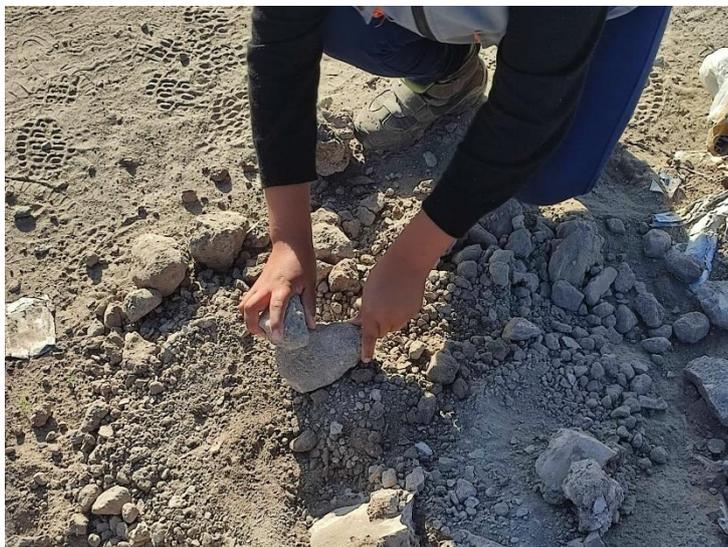
*figura 24. Agregado reciclado grueso*
