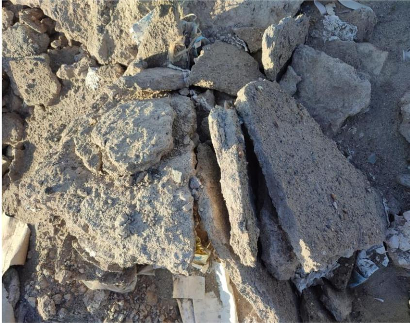
*figura 23. Concreto reciclado seleccionado*
