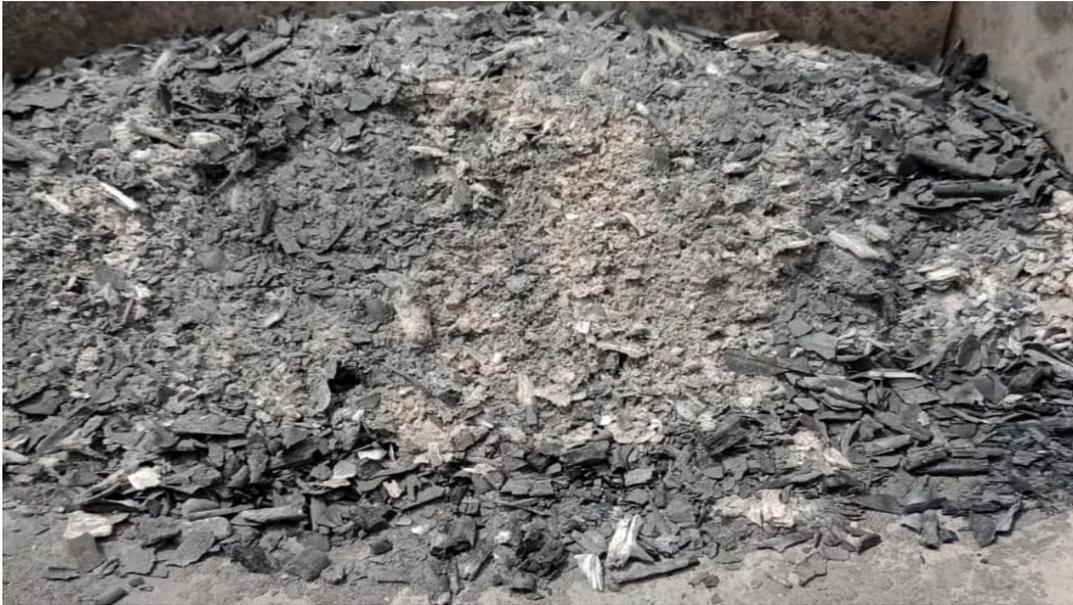
*figura 30. Cenizas volantes de Eucalipto*
