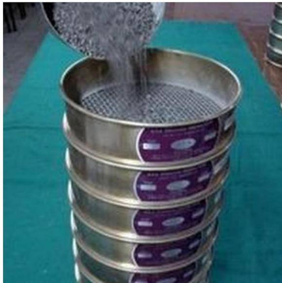
*figura 17. Tamizado de las cenizas*
