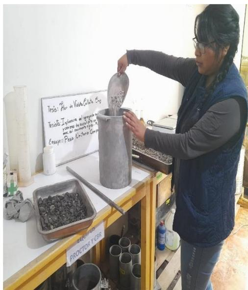
figura 33. Ensayo de peso unitario
