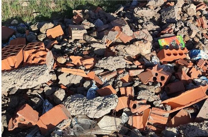
*figura 22. Bloques de concreto de demolicion juntado con otros materiales de construccion*
