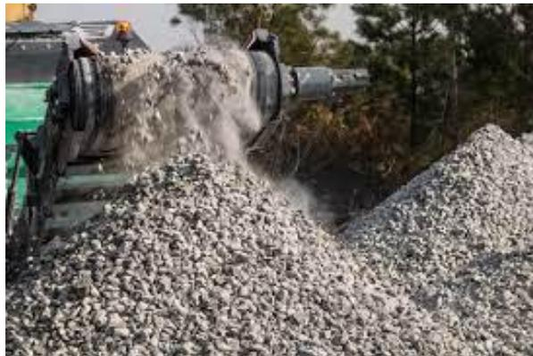
figura 6. Concreto reciclado triturado
