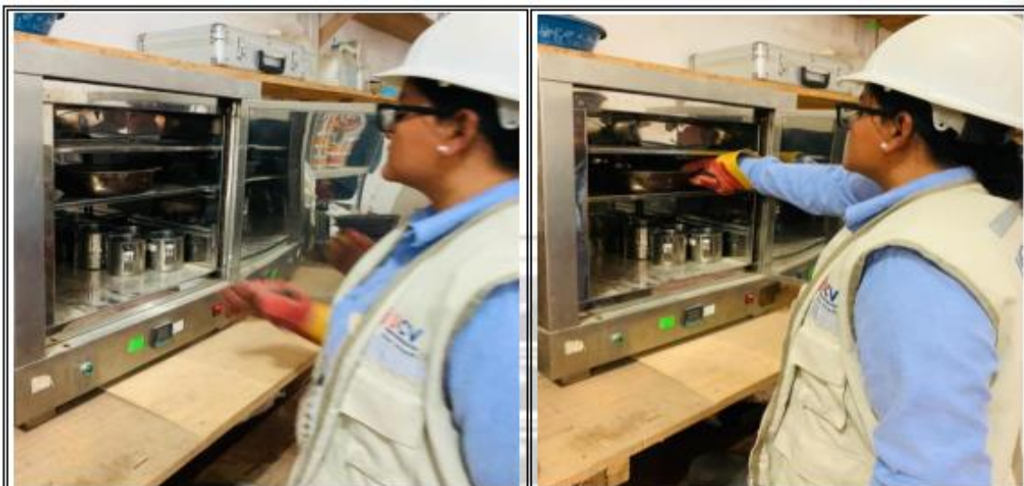
Fotos N° 09-10: En las imágenes podemos observar al personal técnico realizando el ensayo de contenido de humedad.
