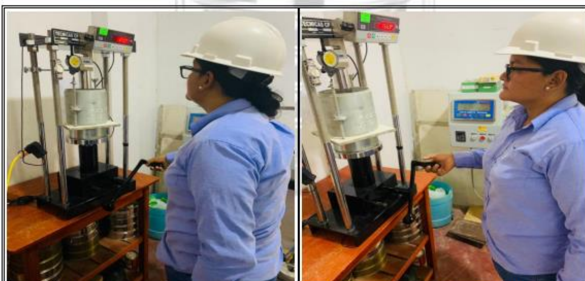
Fotos N° 11-12: En las imágenes podemos observar al personal técnico realizando el ensayo de C.B.R.
