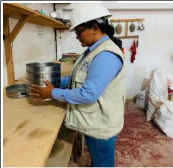
Fotos N° 01-02: En las imágenes se puede visualizar al personal técnico realizando el ensayo de análisis granulométrico.
