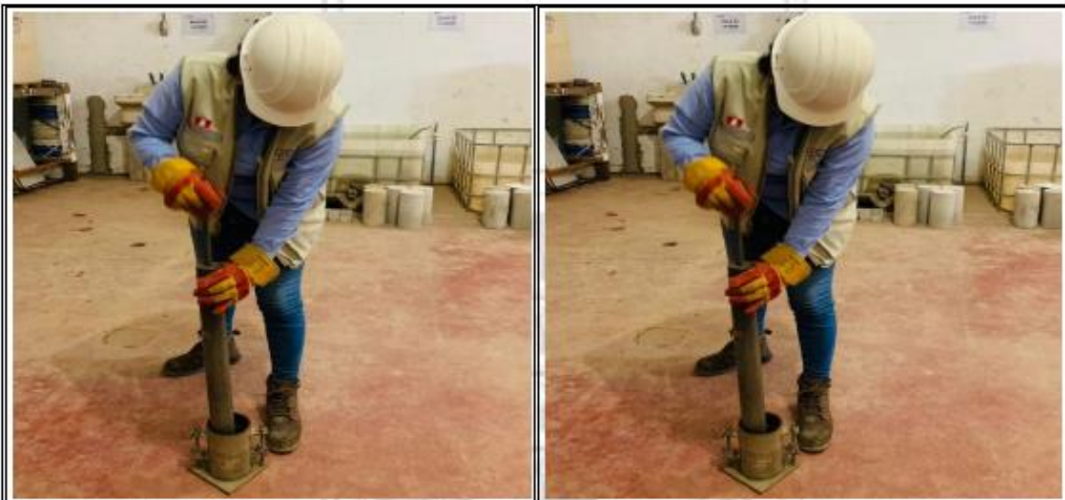
Fotos N° 05-06: En las imágenes podemos observar al personal realizando el ensayo de compactación (Proctor Estándar)
