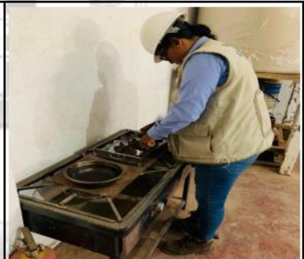
Fotos N° 03-04: En las fotografías observamos el procedimiento de lavado y secado de los materiales.
