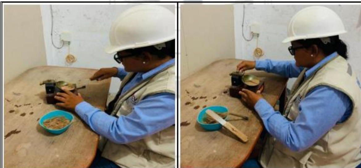
Fotos N° 07-08: En las imágenes podemos apreciar a nuestro personal realizando el ensayo de Límites de Atterberg.
