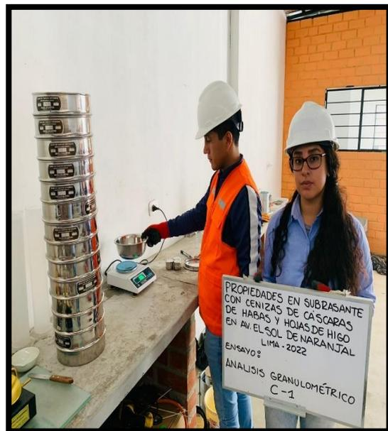
**Figura 22:** Análisis granulométrico
