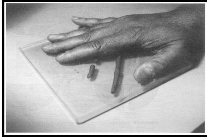
**Figura 14.** Prueba de Limite Plástico
