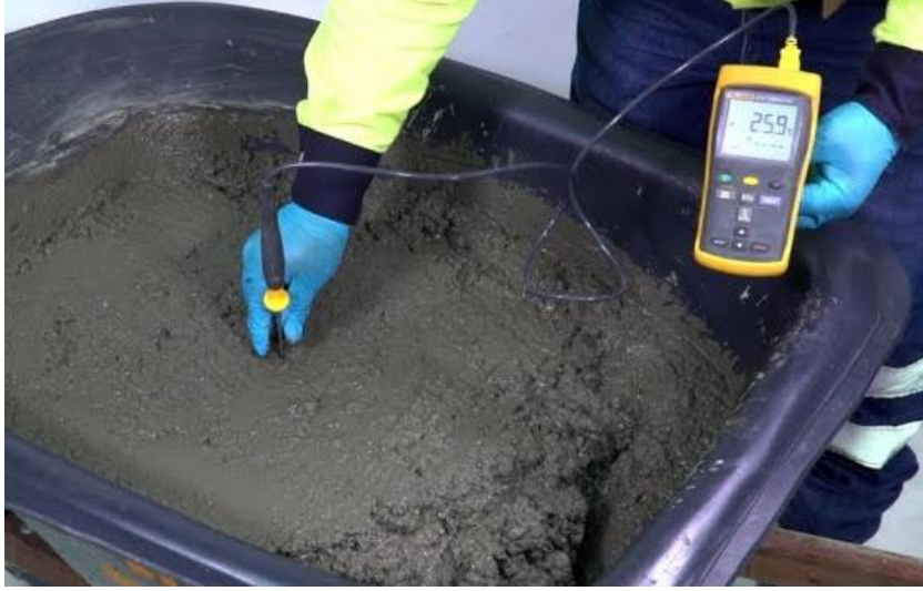
Ilustración 5. Ensayo de temperatura del concreto.
