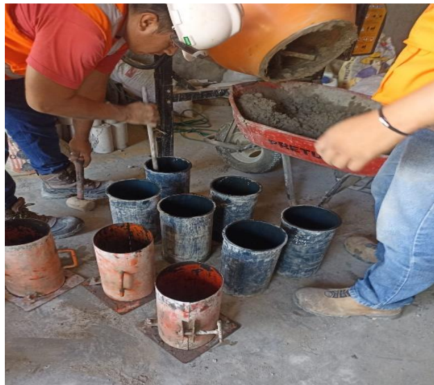
Fotografía N° 18, 19, 20, 21, 22 y 23. Elaboración de testigos cilíndricos para Resistencia a la compresión y tracción.
