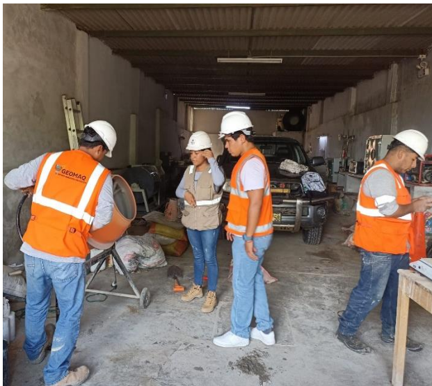
Fotografía N° 18, 19, 20, 21, 22 y 23. Elaboración de testigos cilíndricos para Resistencia a la compresión y tracción.
