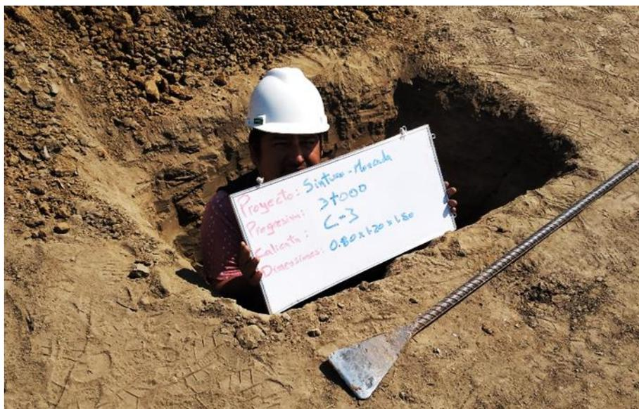
**FOTOGRAFIA N°16:** EXCAVACIÓN DE LA CALICATA N°02 EN LA PROGRESIVA KM 3+000 DE DIMENSIONES 1.20 x 0.80 x 1.50m
