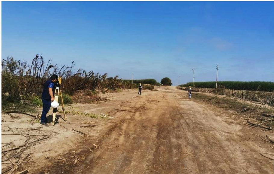
**FOTOGRAFIA N°08:** LEVANTAMIENTO TOPOGRAFICO DEL TRAMO SINTUCO – MONCADA ALTA, DESDE LA PROGRESIVA 0+000 KM AL 13+577 KM.
