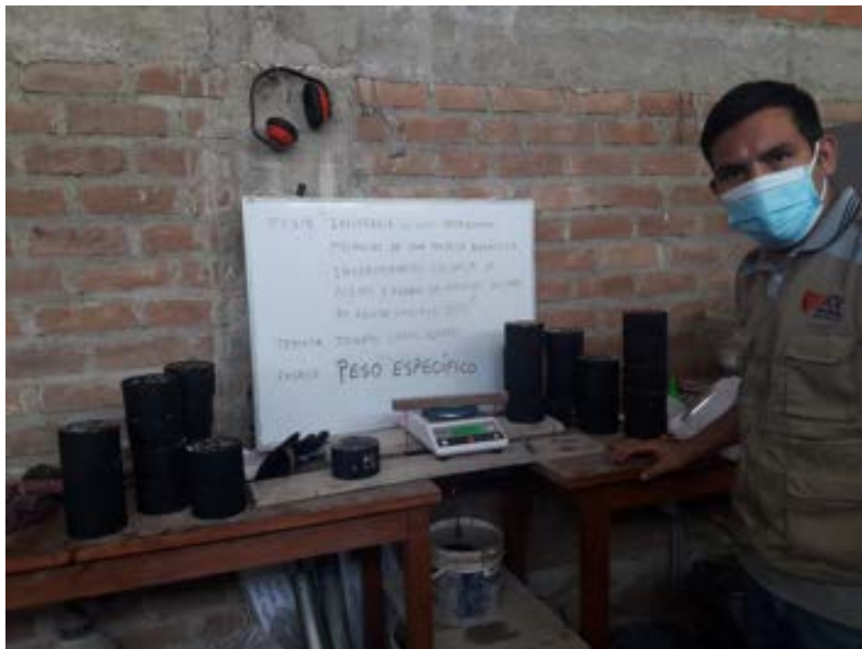
Cálculo de la briqueta sumergida en agua para determinar el peso específico
