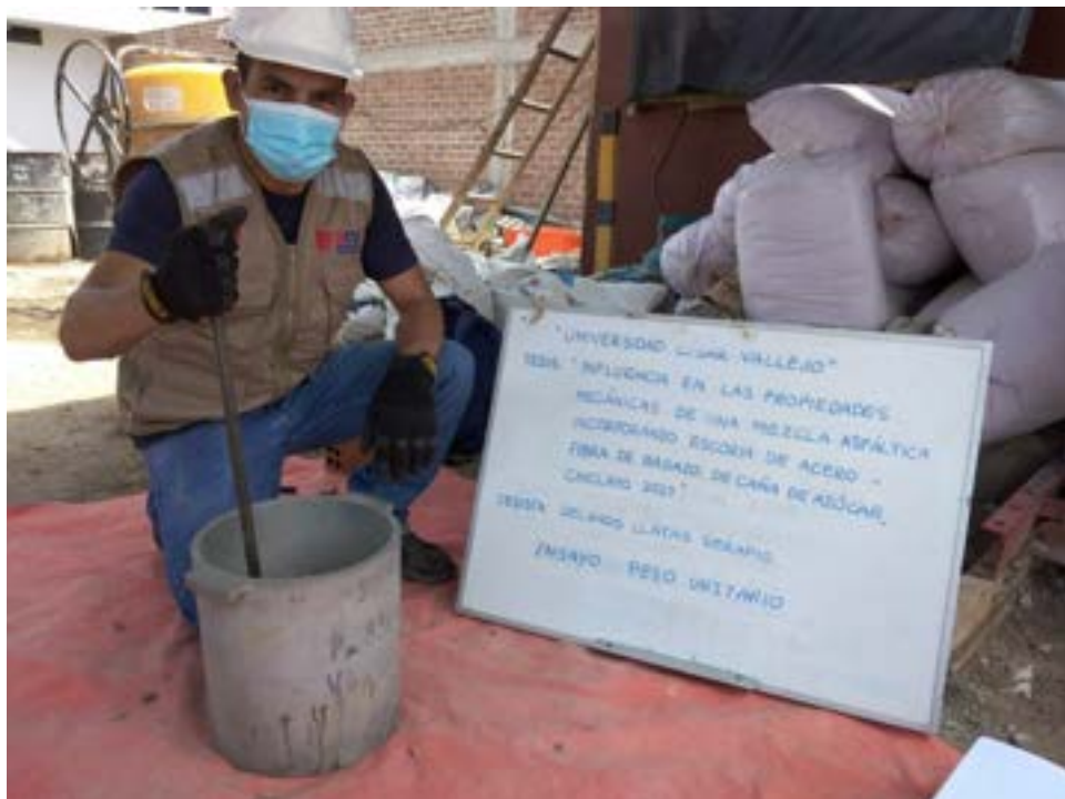
Compactando para determinar el peso unitario
