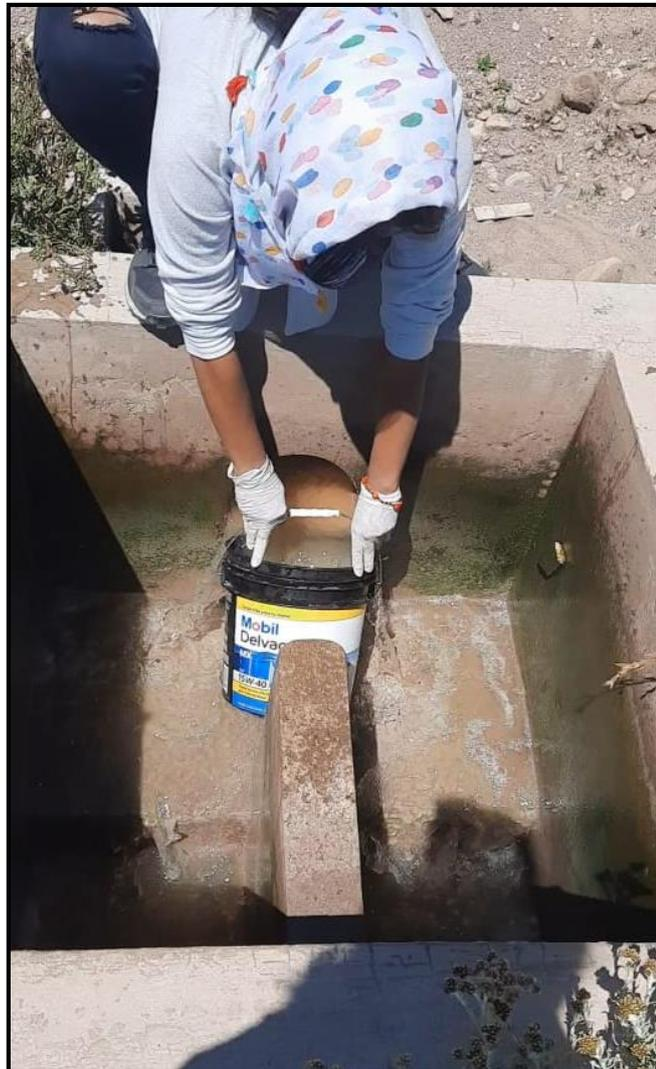
*Figura 16.* Ensayo de método volumétrico.
