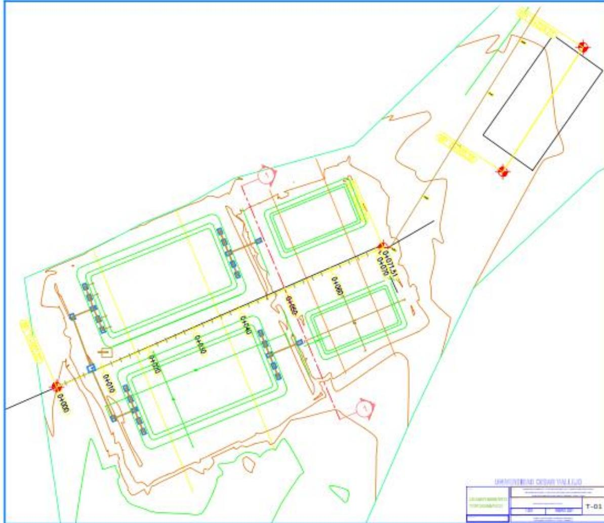
Figura 42. Plano topográfico de las lagunas de estabilización y propuesta del reservorio.
