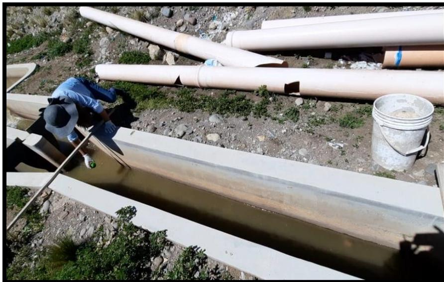
Figura 15: Ensayo del método del flotador. Fuente: Elaboración propia.
