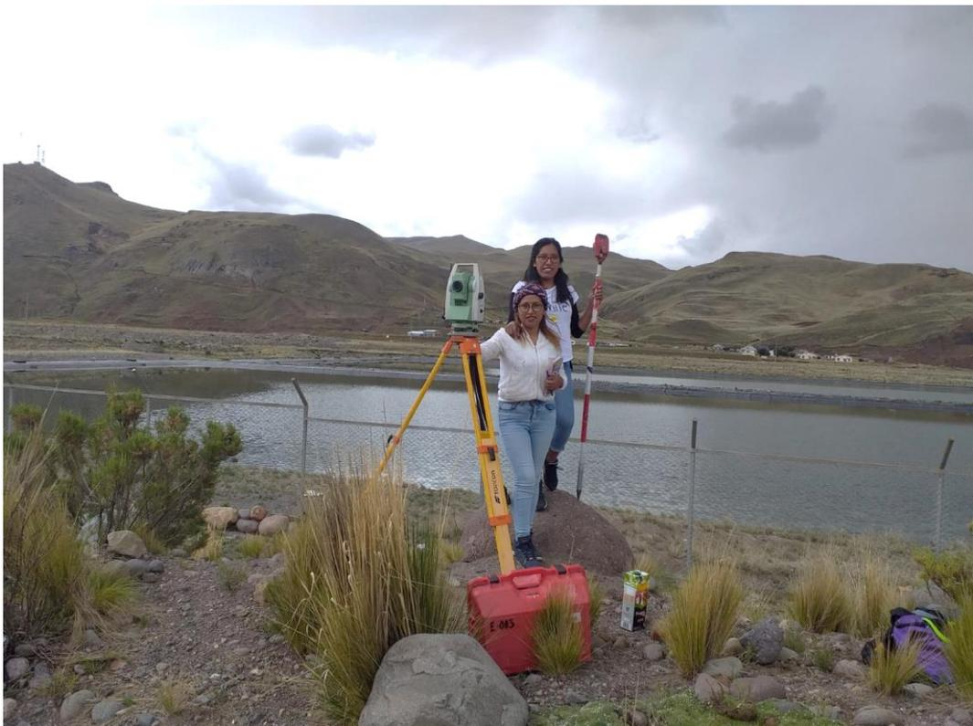
Tesistas con Estación total para el levantamiento topografico
