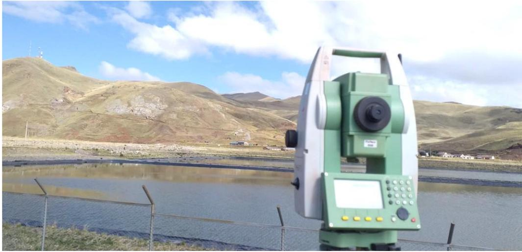
Instrumento utilizado para el levantamiento topografico de la zona
