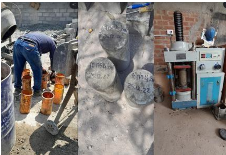
Figura 10. Preparación de Probetas y Aplicación de carga para determinar Resistencia a la compresión
