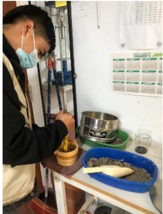
**Figura 4.** Ensayo de contenido de humedad
