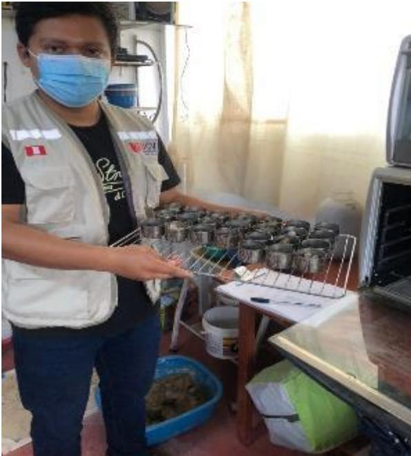
**Figura 1.** Ensayo de contenido de humedad
