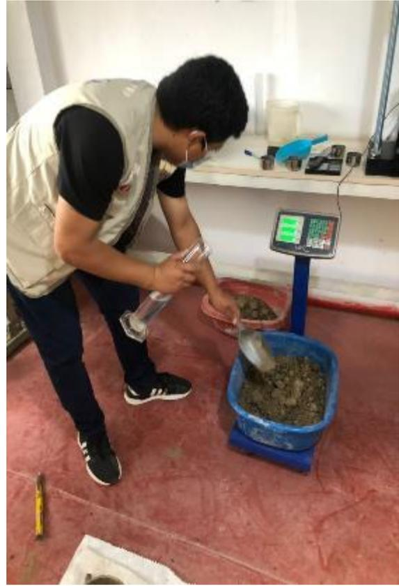
Figura 6. Ensayo de granulometría
