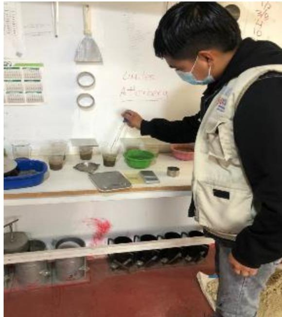
Figura 7. Ensayo de contenido de sales solubles
