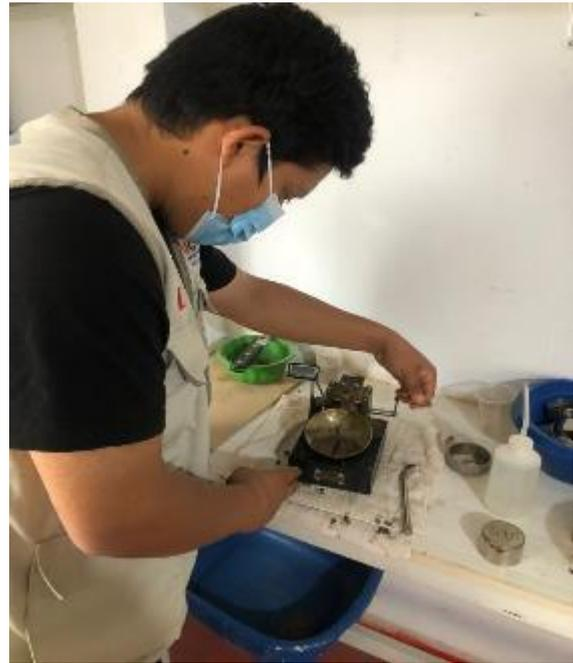
**Figura 2.** Ensayo de límites de consistencia
