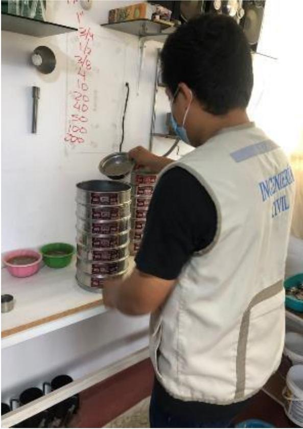
Figura 5. Ensayo de granulometría
