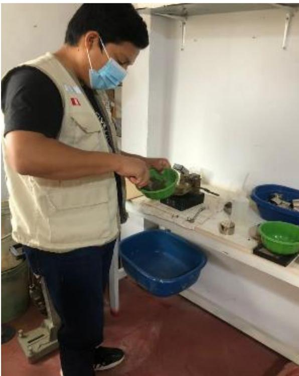
**Figura 3.** Ensayo de contenido de humedad
