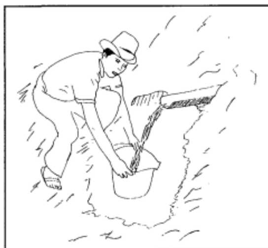
Figura 3.6 : Aforo del agua por el método volumétrico
