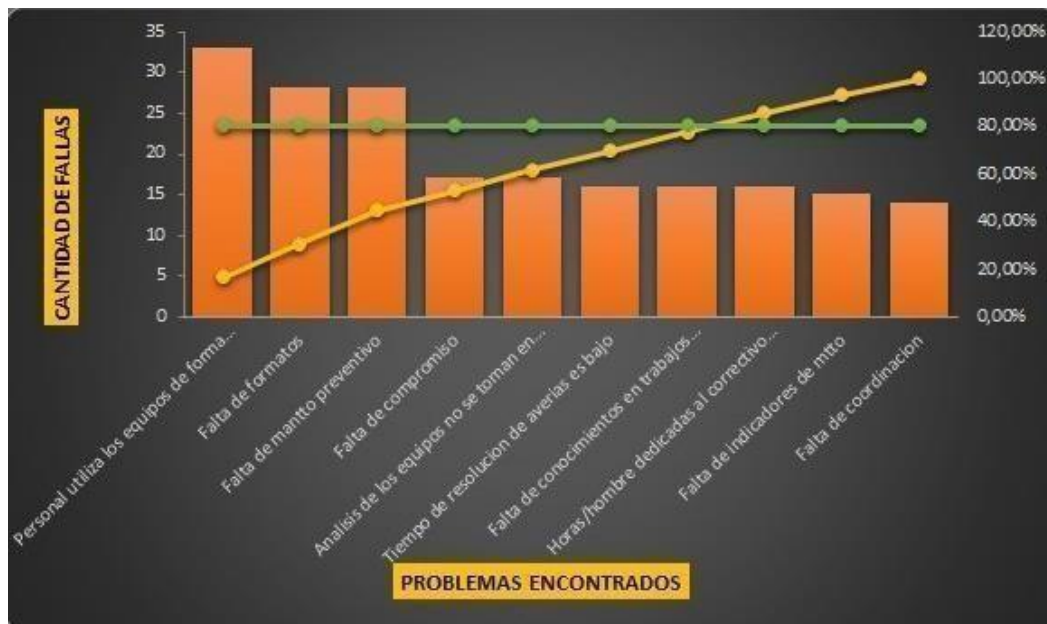
Figura 3: Diagrama de Pareto de los resultados obtenidos en el área de mantenimiento de la empresa Los Ferroles S.A.C.
