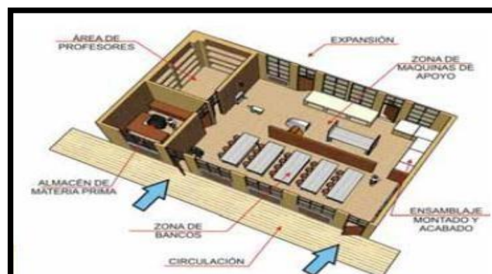
Figura 07: Organización Espacial de Taller de Carpintería en Madera. Fuente: Recuperado de: http://www.minedu.com
