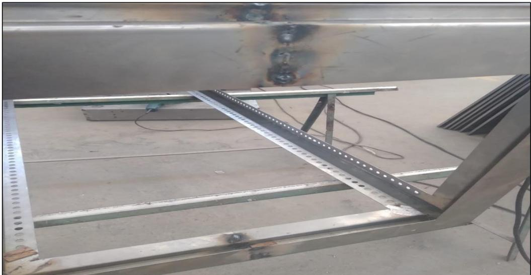
*Figura 1.* Primera estructura metálica que se ha tenido que retirar, parte de ella por causa de una dimensión fallida.
