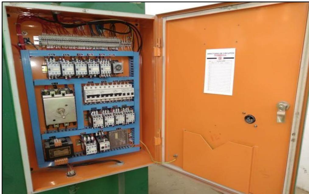
*Figura 9.* Mantenimiento del sistema eléctrico de la dobladora eléctrica.
