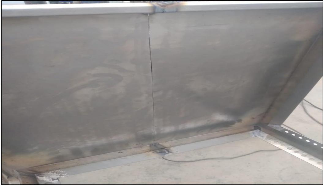
*Figura 2.* Segunda estructura metálica que se ha tenido que retirar, parte de ella por causa de una dimensión fallida.
