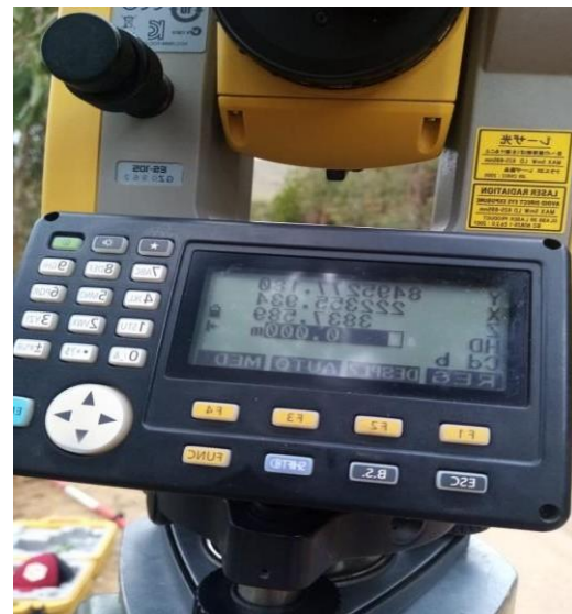
Ilustración 8. Lectura de la estación total para determinar la altura total por diferencia de cotas del E. globulus y P. radiata .
