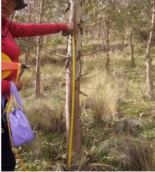
Ilustración 5. Medición del diámetro a la altura del pecho a 1.30m para la especie forestal de E. globulus .
