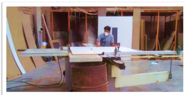
Falta de señalización en equipos y deficiente señalización de paredes
