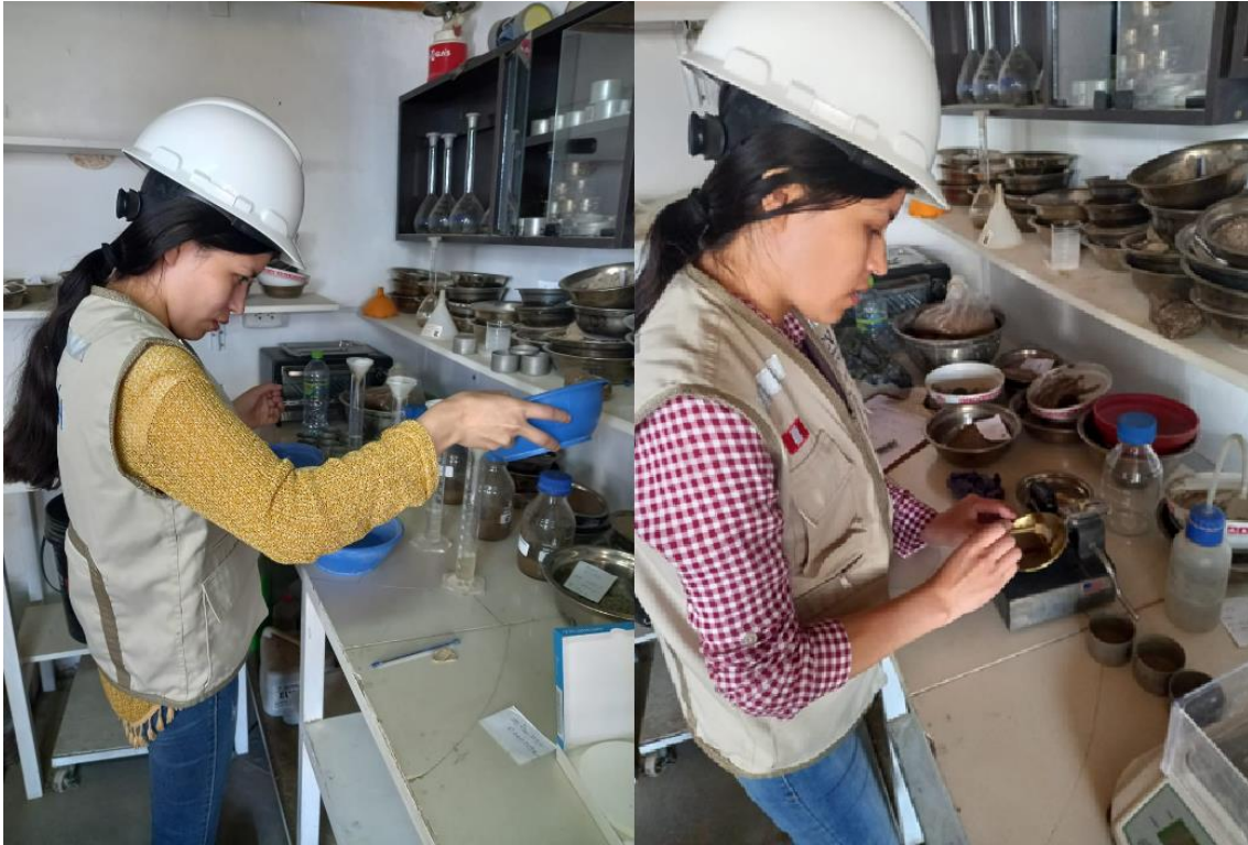
Figura 23 Trabajos realizados en el Laboratorio FERMATI – Estudio de Sales / Límite de Plasticidad
