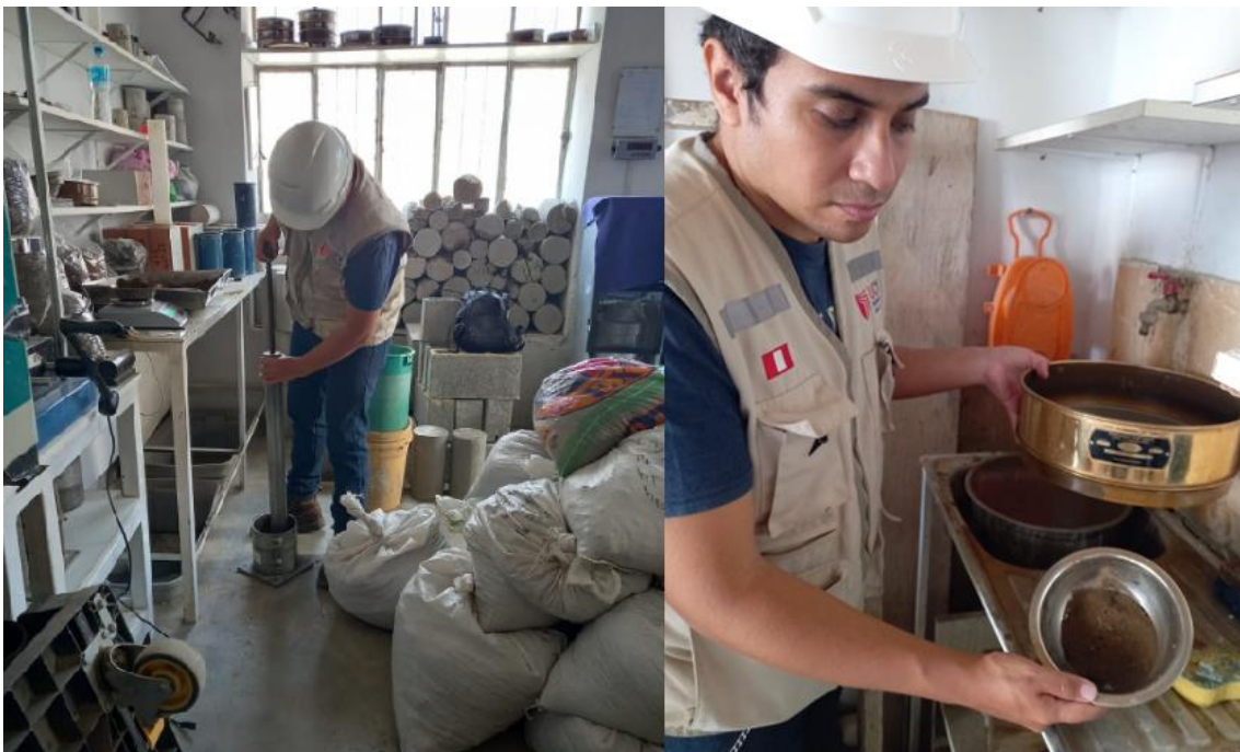
Figura 24 Trabajos realizados en el Laboratorio FERMATI – Proctor / Lavado de Muestras
