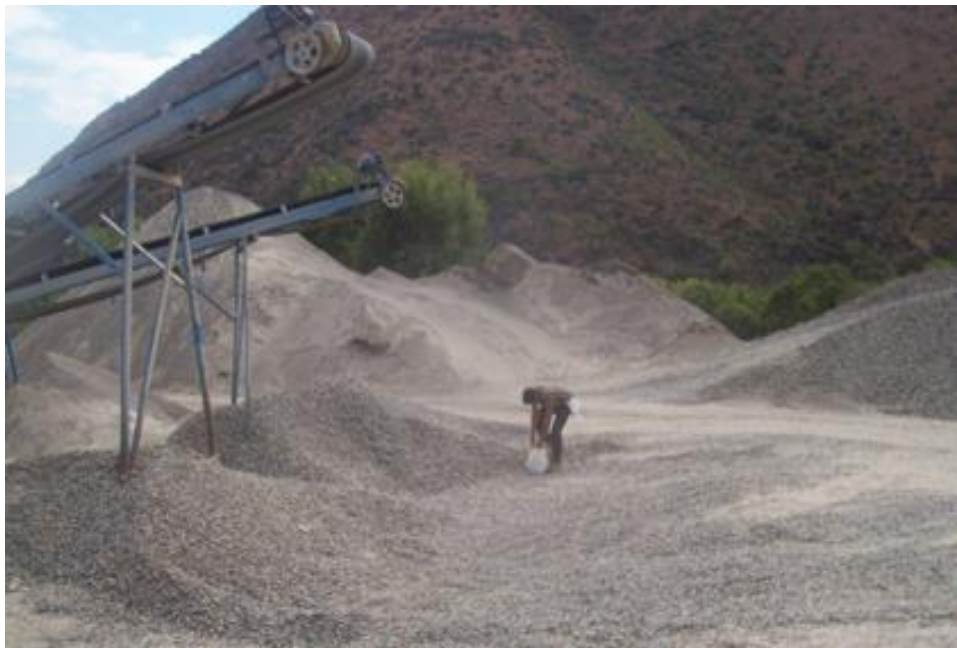
Figura 16. Material procesado con los gruesos de la cantera fluvial del río Huallaga
