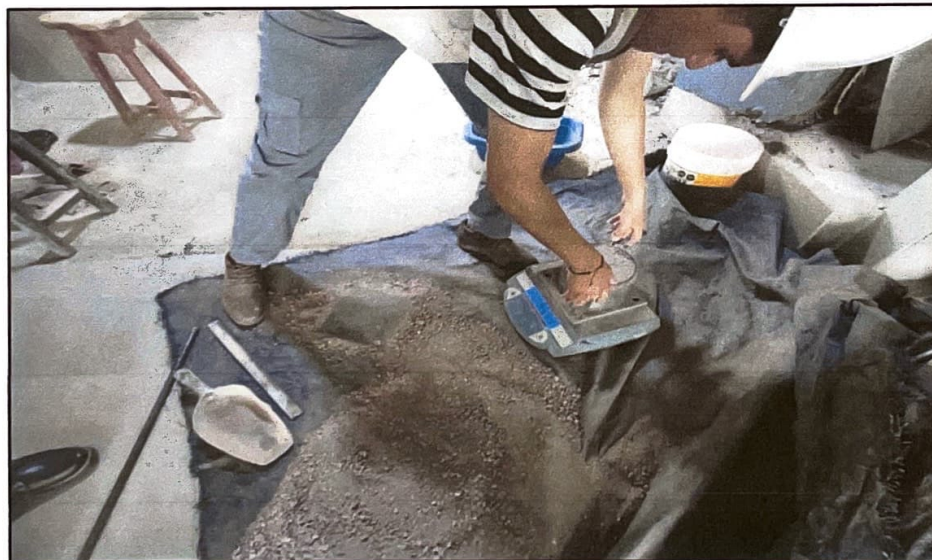
Realización de ensayo de peso volumétrico suelto y peso volumétrico compactado NTP-400.017-2011 (Agregados) Método de Ensayo Para Determinar El Peso Unitario Del Agregado.
