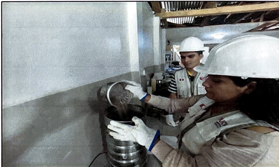
Análisis granulométrico del agregado fino, grueso y global NTP 400.012 - AGREGADOS. Proceso de pesado para lavado y tamizado mecánico manual por la fracción fina de tamices.
