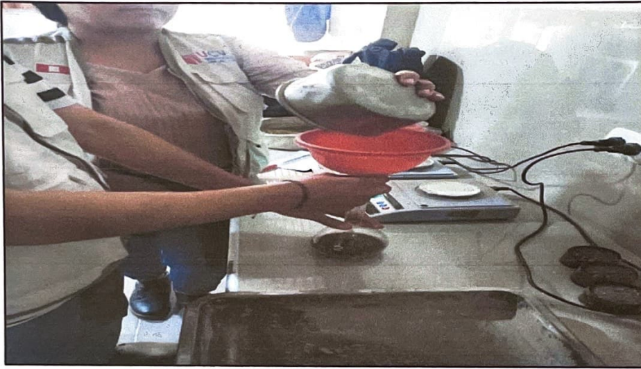
Realización de ensayo de porcentaje de absorción del agregado fino (arena de piedra chancada tamaño máximo \frac{3}{8} " (peso específico) y absorción del agregado fino NTP 400.022 – 2013.
