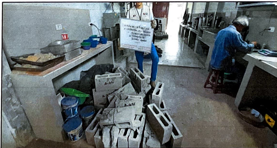
Realización de ensayo normalizado para la determinación de la resistencia a la compresión de los ladrillos en distintas proporciones de adición de fibra de bambú, y muestras patrones. NTP 339.034 – 2008.
