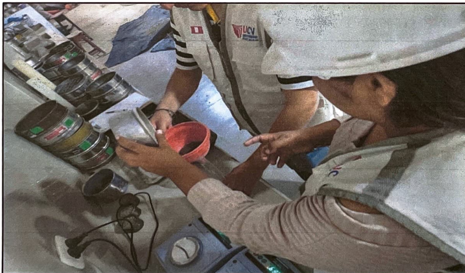
Realización de ensayo de porcentaje de absorción del agregado fino (arena de piedra chancada tamaño máximo \frac{3}{8} " (peso específico) y absorción del agregado fino NTP 400.022 – 2013.
