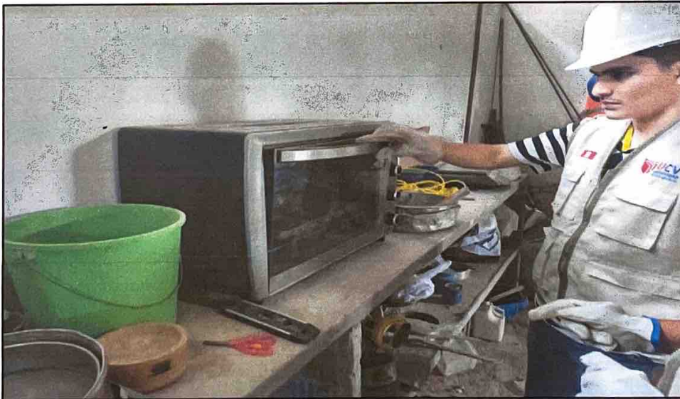
Proceso de ensayo humedad constante evaporable de los agregados a 110° C - Ensayo de Contenido de Humedad NTP 339.127. proceso de secado en horno.
