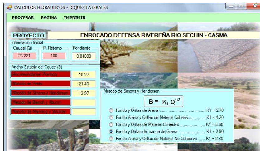
Imagen N°8: En el Método Simons y Henderson, para obtener el Ancho Estable del Cauce, muestra condiciones de fondo y orilla del río.
