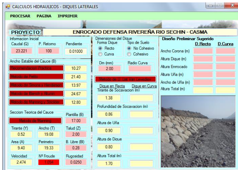
Imagen N°10: Para el Ancho Estable del Cauze por el Método de Manning, se considera el coeficiente de rugosidad, del tipo de material y el cauce
