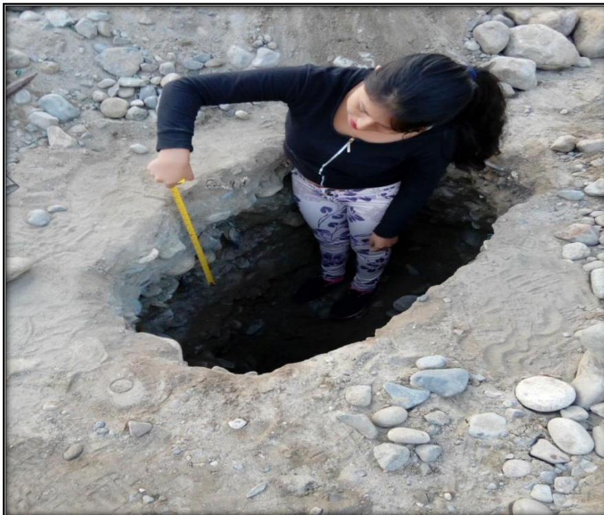
Imagen N°12: Se puede apreciar una de las calicatas que se realizó para extraer una muestra y llevarlo al laboratorio y poder saber el tipo de suelo de la zona de estudio.
