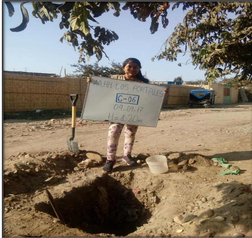
Imagen N°12: Se puede apreciar una de las calicatas que se realizó para extraer una muestra y llevarlo al laboratorio y poder saber el tipo de suelo de la zona de estudio.
