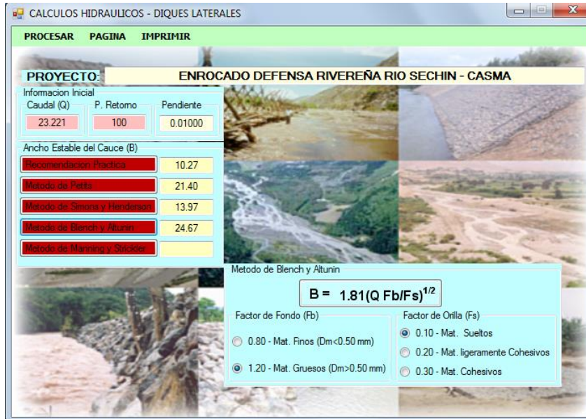
Imagen N°9: Para el Ancho Estable del Cauze por el Método de Blench y Altunin, se considera el factor de fondo y el factor de orilla
