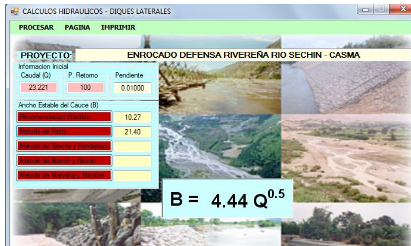
Imagen N°7: Ancho Estable del Cauce por el Método Petis
