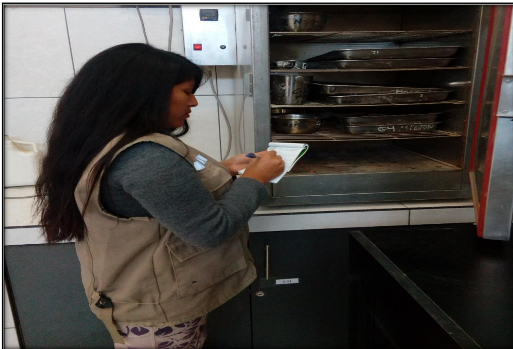
Imagen N°14: Se realizó el ensayo de contenido de humedad, mediante la imagen se aprecia una pequeña muestra en el horno.
