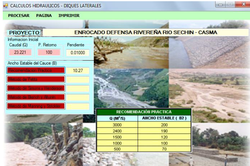
Imagen N°6: Ancho Estable del Cauce por Recomendación Práctica.
