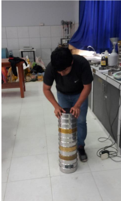
FOTOGRAFIA 05: Se realizó el ensayo de analisis granulométrico desde el tamiz \frac{3}{4} hasta el N° 200.
