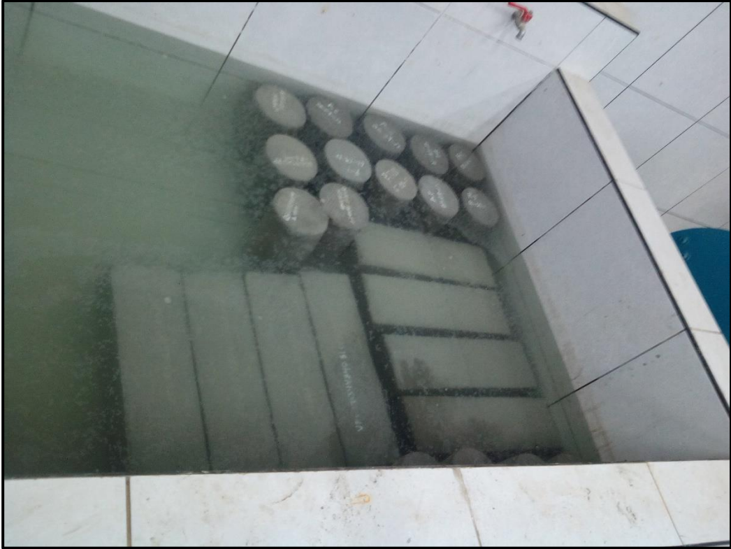
FOTO N°21: Vista del curado de las vigas y las probetas de concreto.
