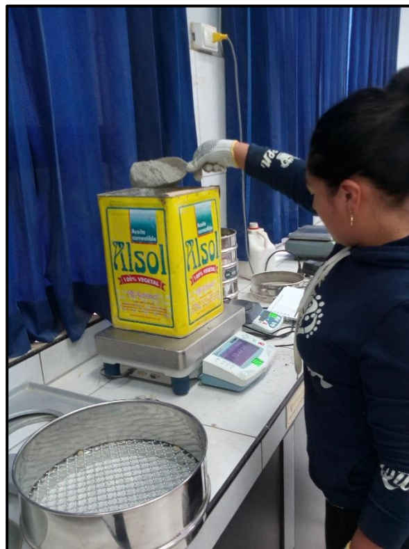
FOTO N°14: Vista de los trabajos de pesaje del mucilago de tuna para la mezcla.
