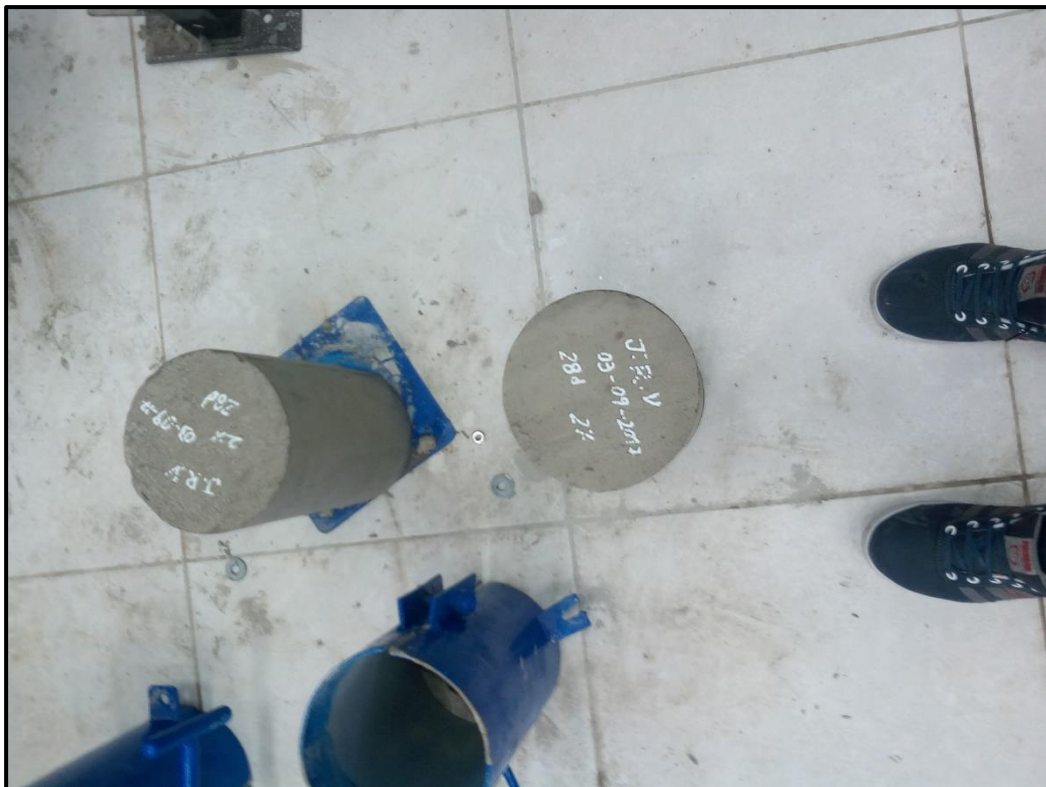
FOTO N°20: Vista del desencofrado de las probetas de concreto.
