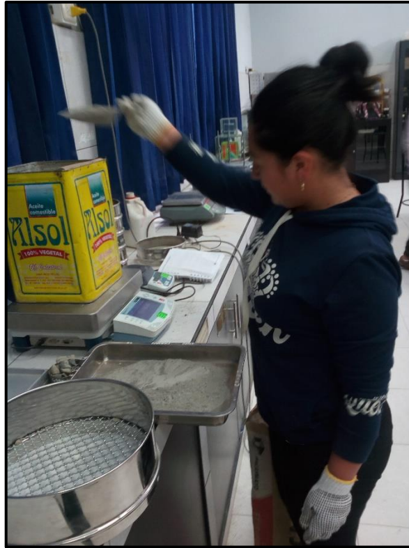
FOTO N°13: Vista de los trabajos de pesaje del cemento para la mezcla.
