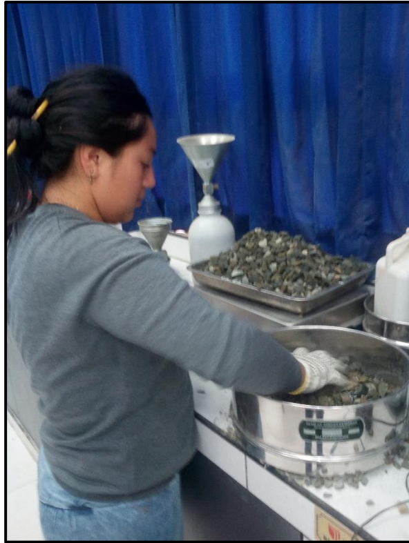
FOTO N°11: Vista de los trabajos de pesaje de la piedra para la mezcla.
