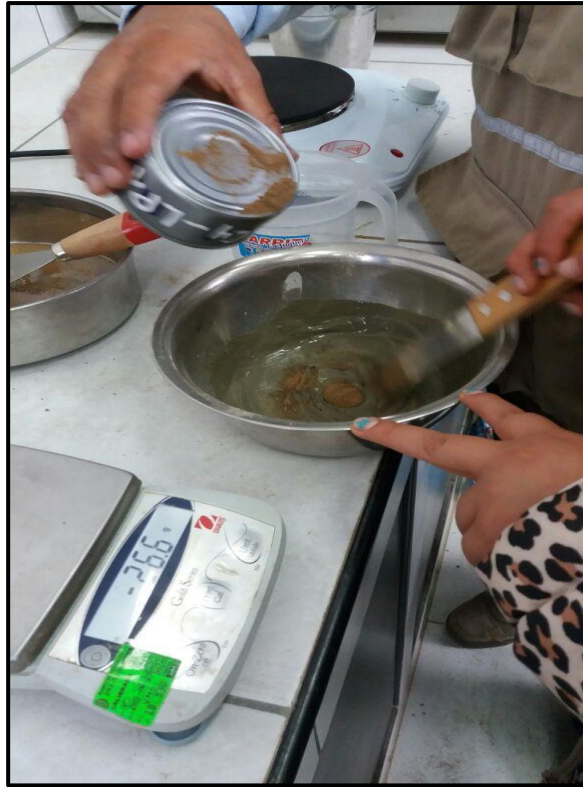
FOTO N°15: Vista de los trabajos para determinar la relación agua-cemento con adición de mucilago de tuna.
