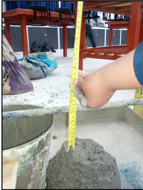
FOTO N°17: Vista de la conformidad de slump 3 a 4" de la mezcla elaborada.
