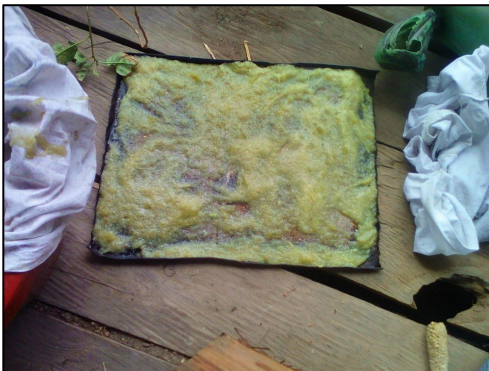
FOTO N°06: Vista de la preparación del mucilago en moldes de pan, en láminas menores de 1cm de espesor.
