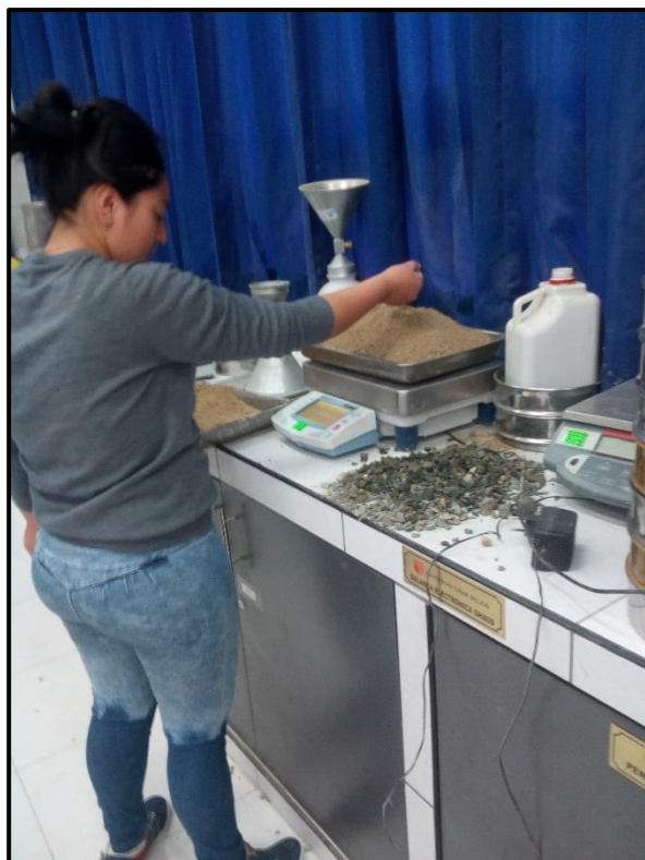
FOTO N°12: Vista de los trabajos de pesaje de la arena para la mezcla.
