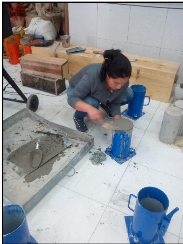
FOTO N°18: Vista de la elaboración de las probetas de concreto.
