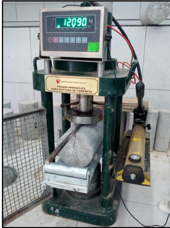
FOTO N°21: Vista del ensayo con la prensa hidráulica a las probetas de concreto para determinar la resistencia a la tracción.
