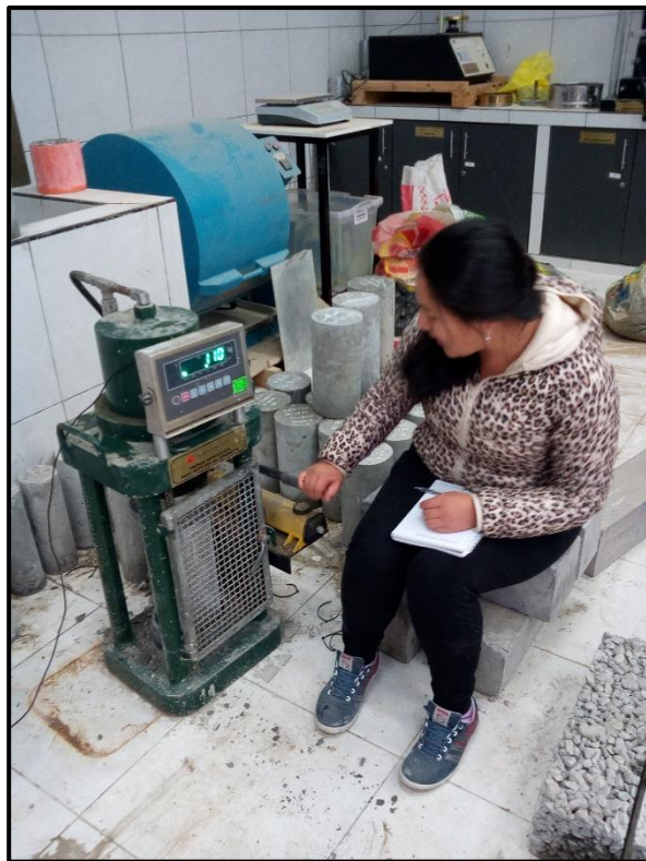
FOTO N°22: Vista del ensayo con la prensa hidráulica a las probetas de concreto para determinar la resistencia a la compresión.
