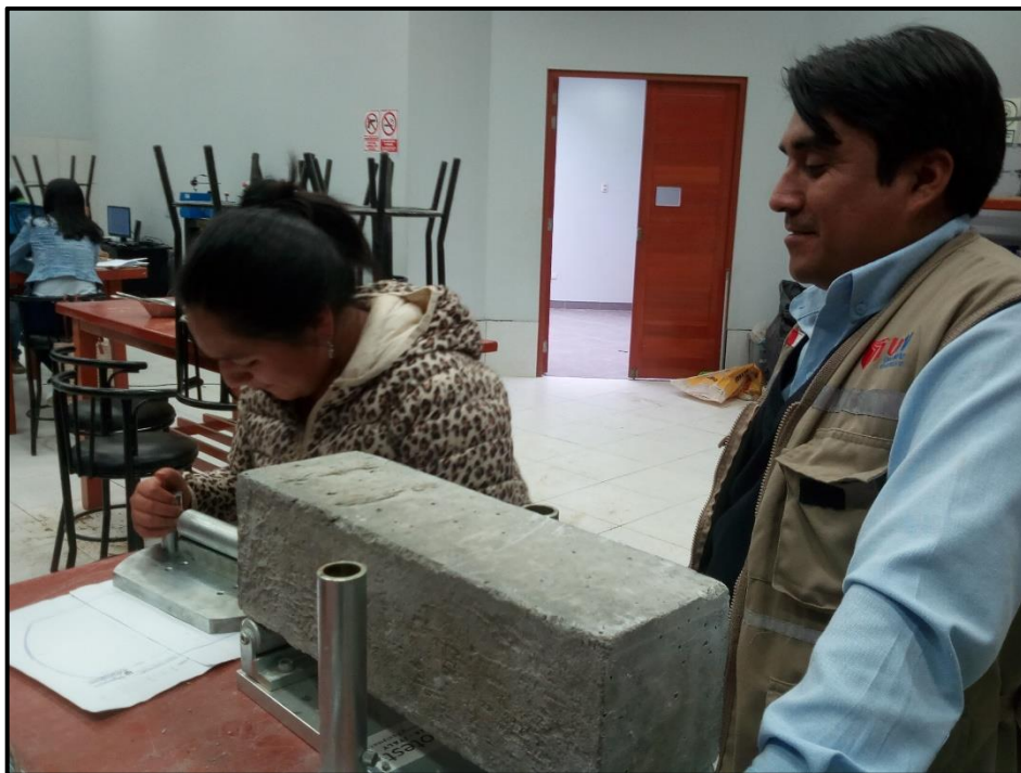
FOTO N°21: Vista del ensayo con la prensa hidráulica a las vigas de concreto para determinar la resistencia a la flexión.
