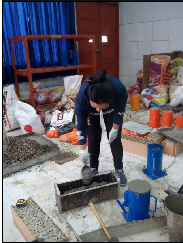
FOTO N°19: Vista de la elaboración de las vigas de concreto.
