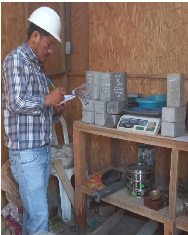
Ensayos de absorcion en aduquines
