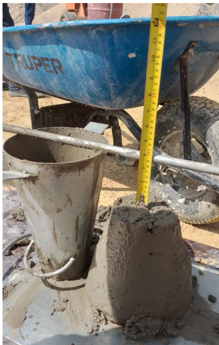
Figura 16: Slump de 4" para el diseño de mezcla
