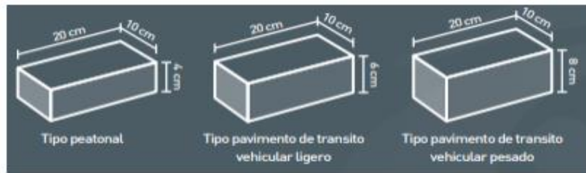
Figura2: Dimensiones de adoquines según su tipo
