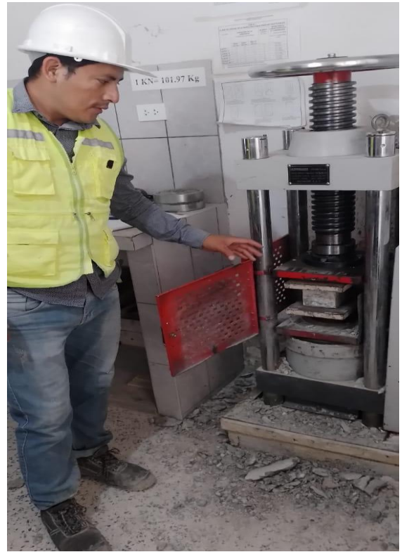
Ensayo de rotura de aduquines f'c
