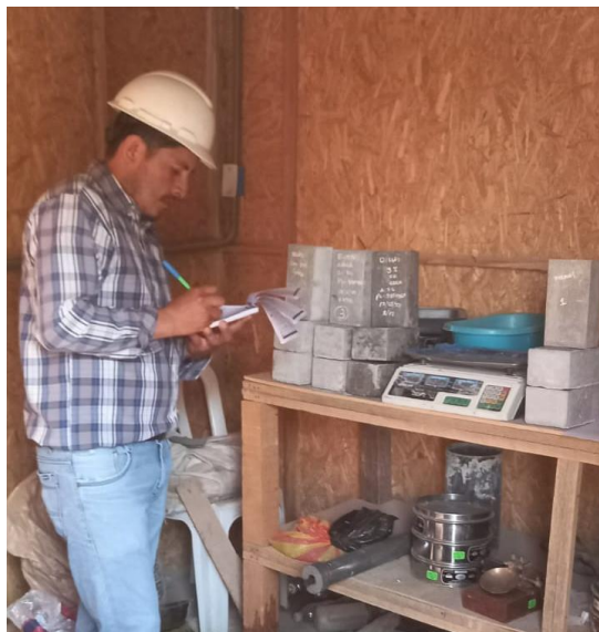
Figura 22: Muestras y procedimientos para ensayo de absorción
