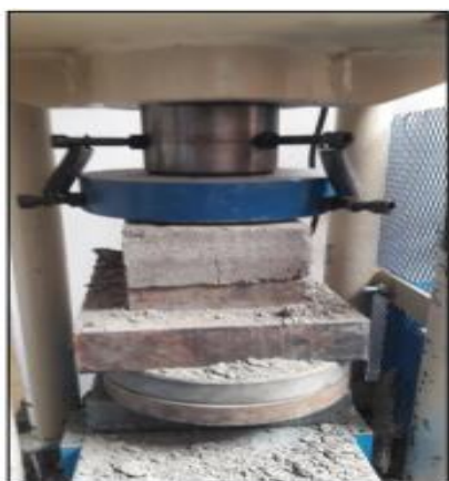
Figura 6: Rotura de adoquín con prensa hidráulica
