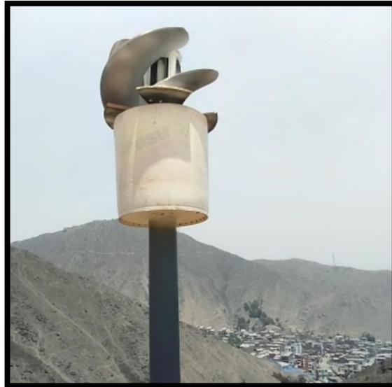
**Foto N°1:** Dispositivo de turbina Savonius en área de estudio (Elaboración: propia)
