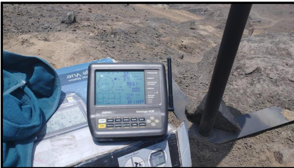
**Figura N.º 15: consola de medición de parámetros atmosféricos**
