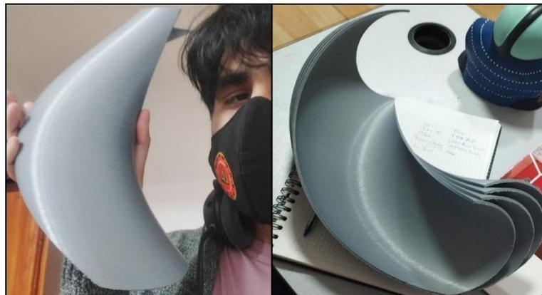
**Figura N°10:** Modelo 3D impreso de las aspas **Fuente:** Elaboración propia
