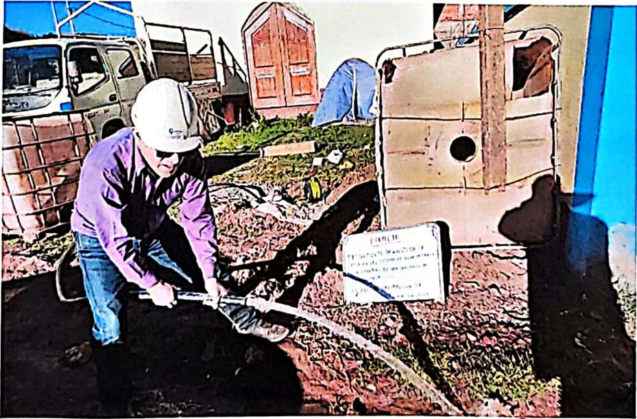
Prueba de bombeo – con bomba sumergida de 0.5 HP, 1.00 HP y 2.00 HP
