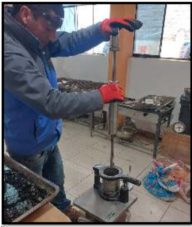
FOTO 06: Se observa la realización del ensayo Marshall
