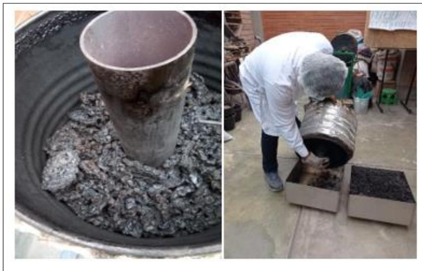
Figura 7. Biocarbón de piña después del proceso de pirólisis.
