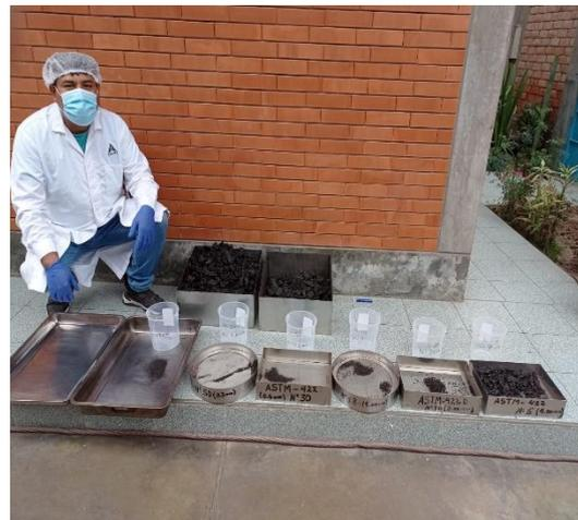
Obtención del bioadsorbente por pirólisis
