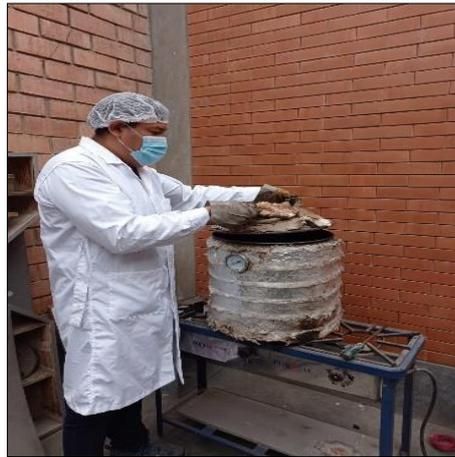
*Figura 6. Reactor anaeróbico*
