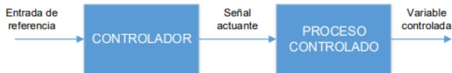
*Fig. 2 Sistema de control en lazo abierto.*
