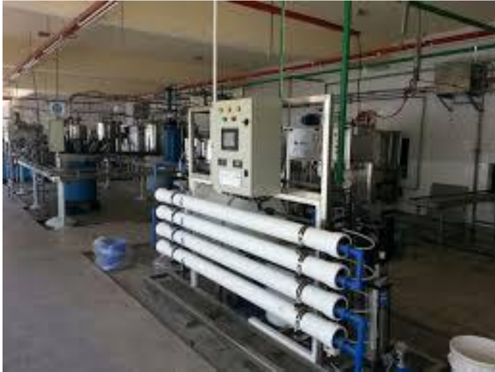
Figura 15. Tecnología de reuso de Membranas osmóticas Fuente : Elaboracion Propia
