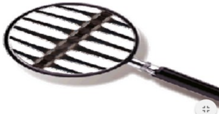
Figura 02. Detalle de costilla geomalla uni-axial
