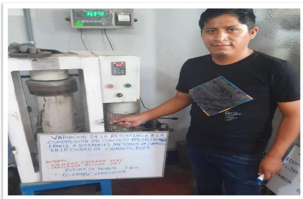
**Descripción:** Rotura de las probetas de verificación, a los 7 días de edad.
