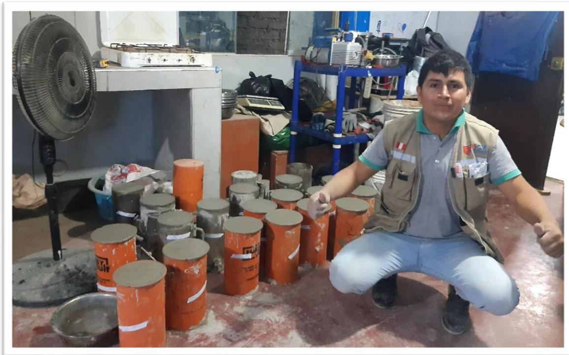
**Descripción:** Moldeo de concreto 175kg/cm<sup>2</sup>, 210kg/cm<sup>2</sup> y 280kg/cm<sup>2</sup>
