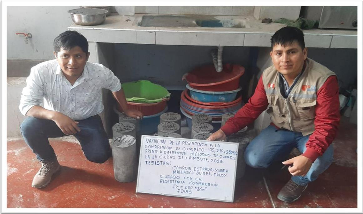
Descripción: Rotura de probeta a los 7 días de edad, Curado con Cal.
