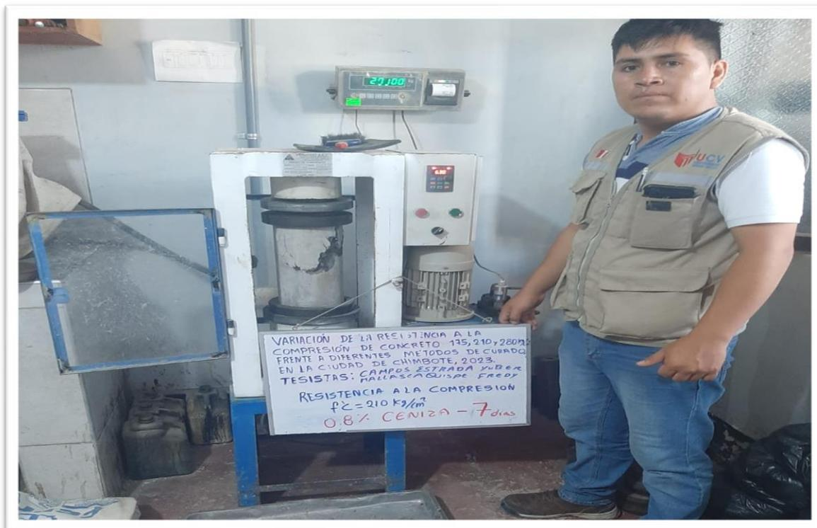
**Descripción:** Rotura de probeta a los 7 días de edad, Curado con Ceniza.
