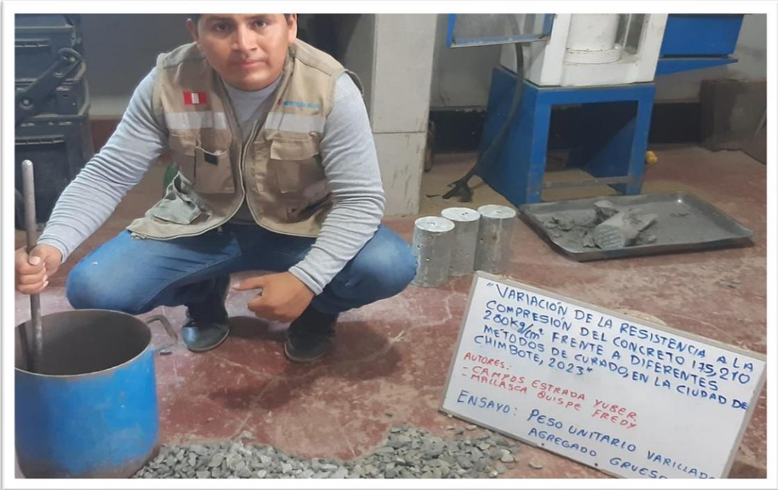
Descripción: Varillado del agregado en tres capas, y cada capa por 25 golpes.
