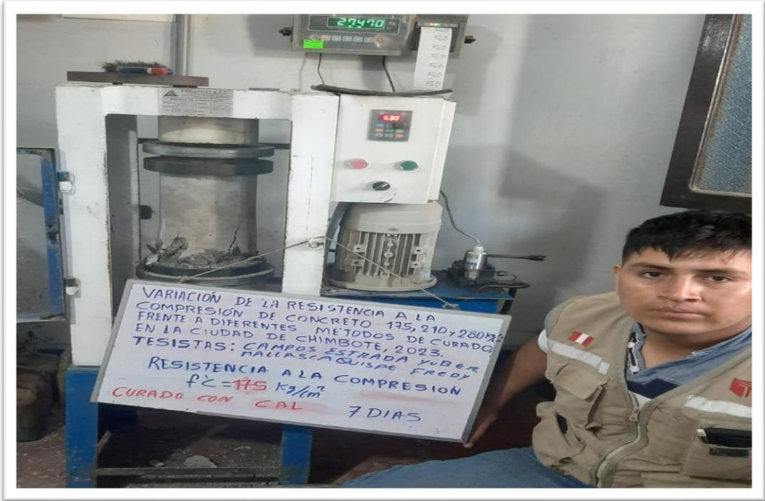
Descripción: Rotura de probeta a los 7 días de edad, Curado con Cal.
