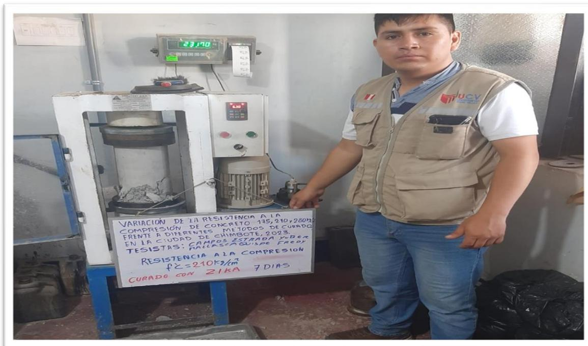
**Descripción:** Rotura de probeta a los 7 días de edad, Curado con Sika
