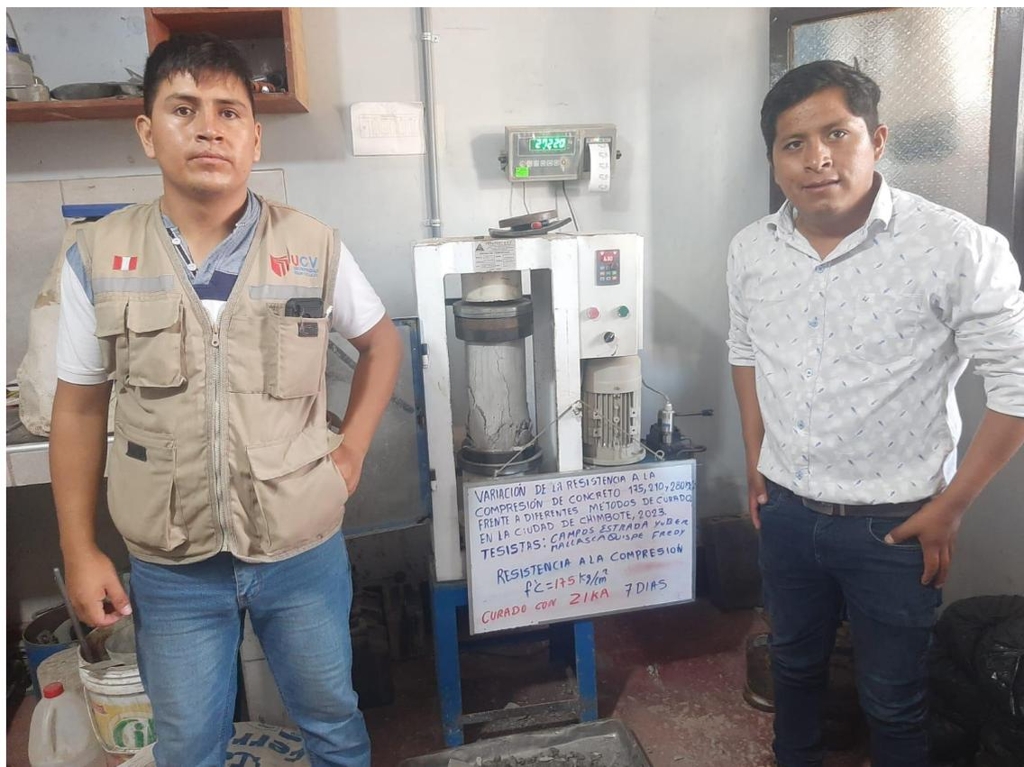
**Descripción:** Rotura de probeta a los 7 días de edad, Curado con Sika
