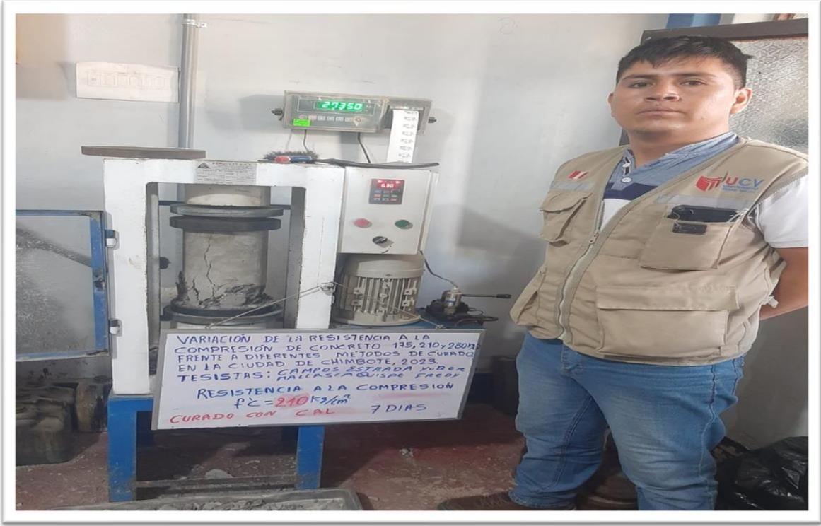
Descripción: Rotura de probeta a los 7 días de edad, Curado con Cal.
