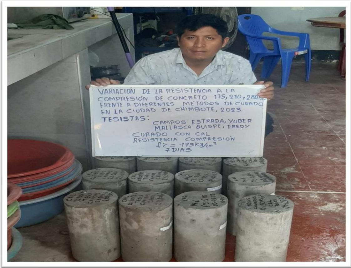
Descripción: Rotura de probetas a los 7 días de edad, Curado con Cal.
