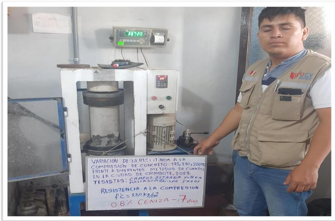
**Descripción:** Rotura de probeta a los 7 días de edad, Curado con Ceniza.
