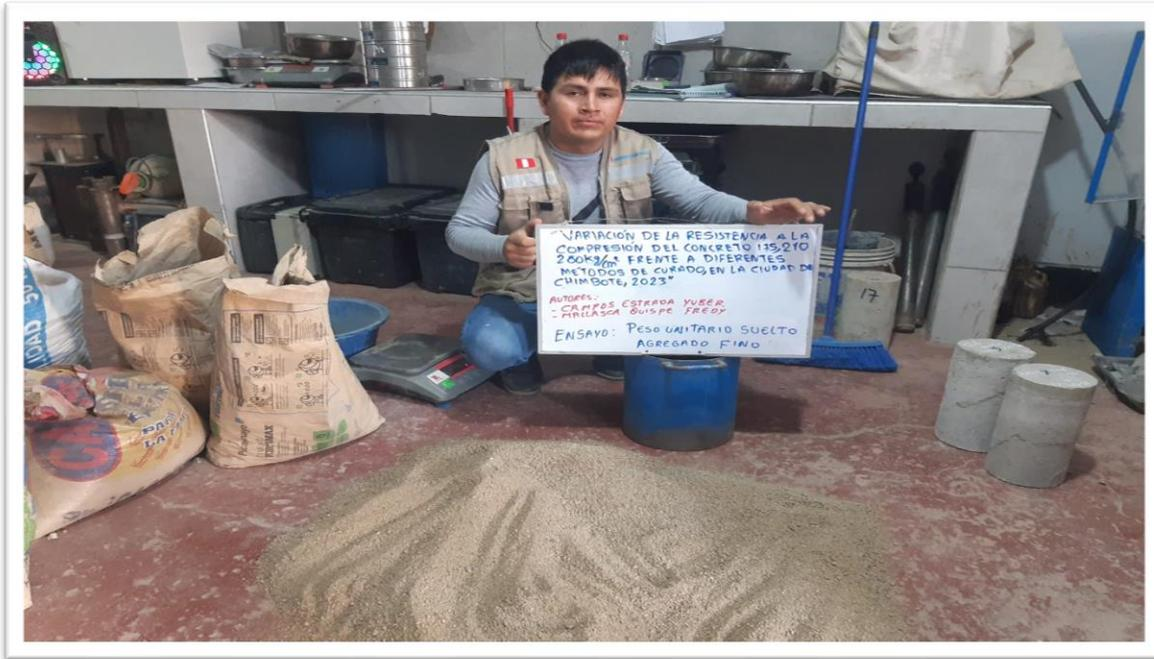
**Descripción:** Cuarteo del agregado fino y llenado en el molde, y obtención del peso del agregado en kilogramos.
