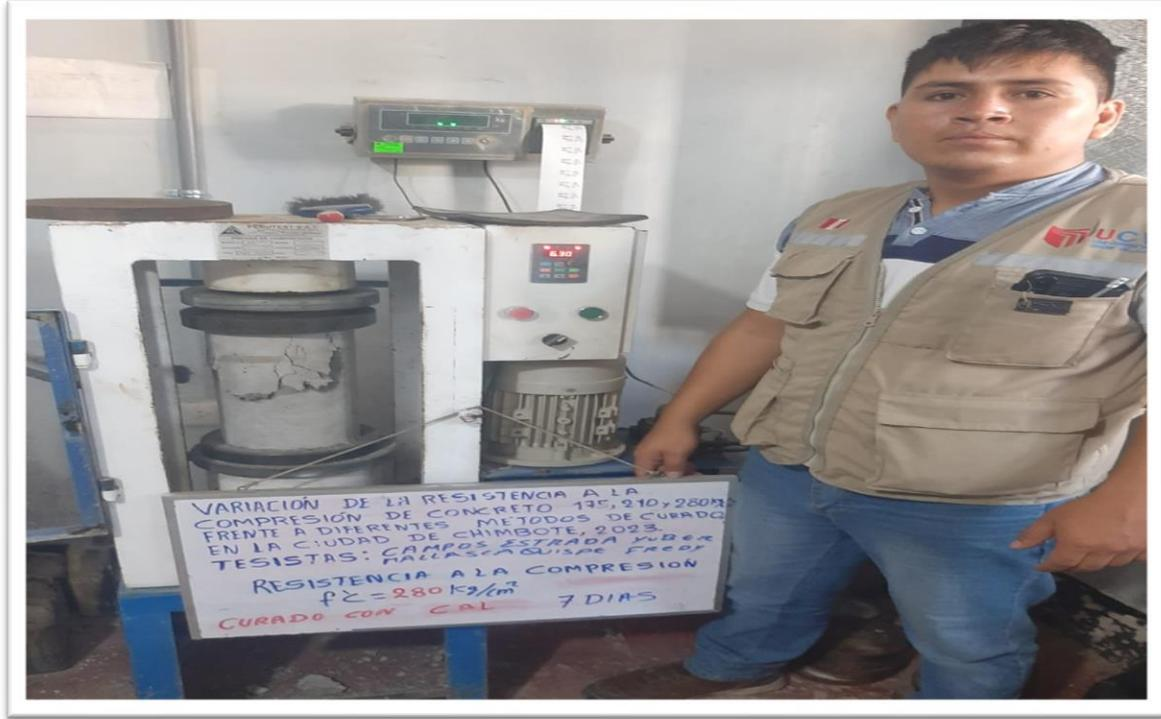
Descripción: Rotura de probeta a los 7 días de edad, Curado con Cal.
