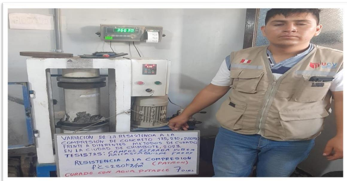
**Descripción:** Rotura de probeta a los 7 días de edad, Curado con Agua potable "patrón".
