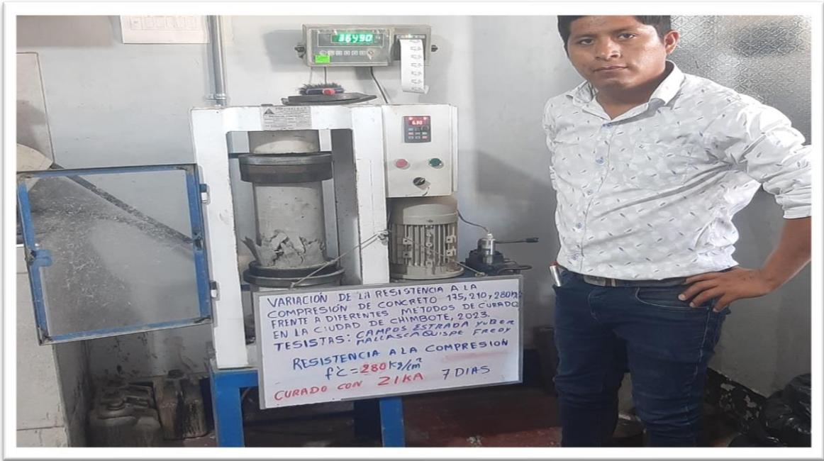
Descripción: Rotura de probeta a los 7 días de edad, Curado con Sik
