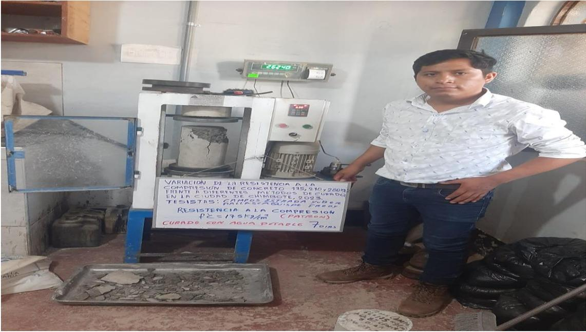
**Descripción:** Rotura de probeta a los 7 días de edad, Curado con Agua potable “patrón”.
